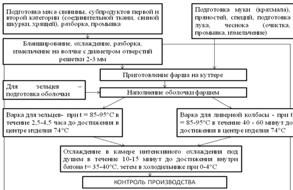
Рис. – Общая технологическая схема производства зельцев и ливерной колбасы
