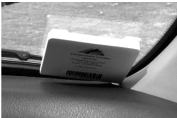
Рис. 3 – RFID-метка на лобовом стекле автомобиля
