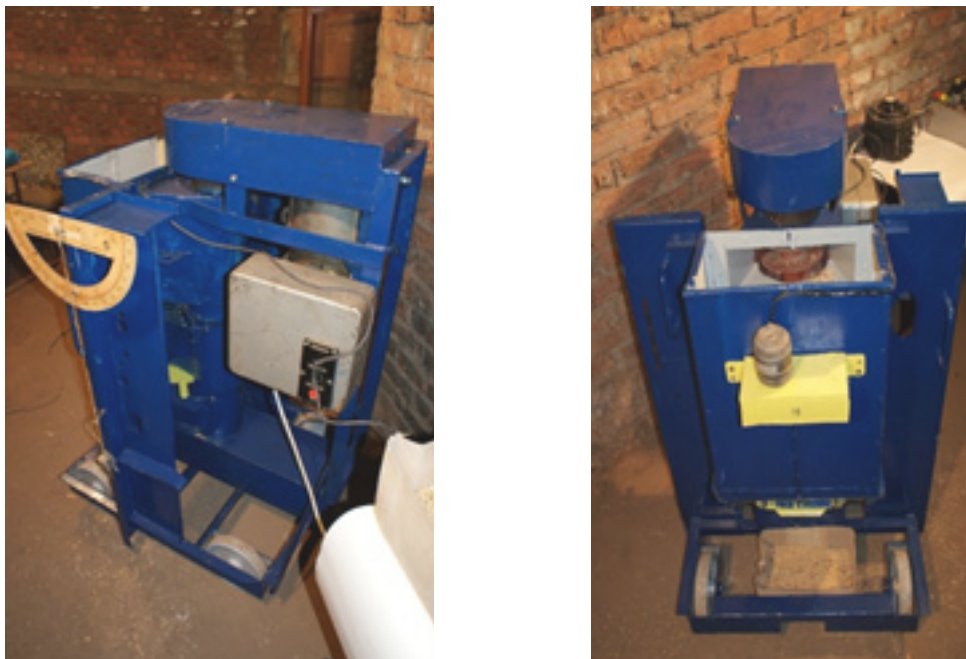
Рис. 2 – Внешний вид производственного образца смесителя-обогапителя концентрированных кормов
