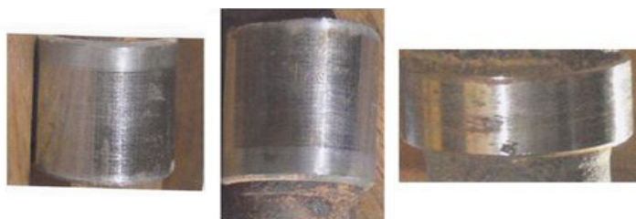
Рис.4 – Поверхность вала после контакта со специальной резиной
