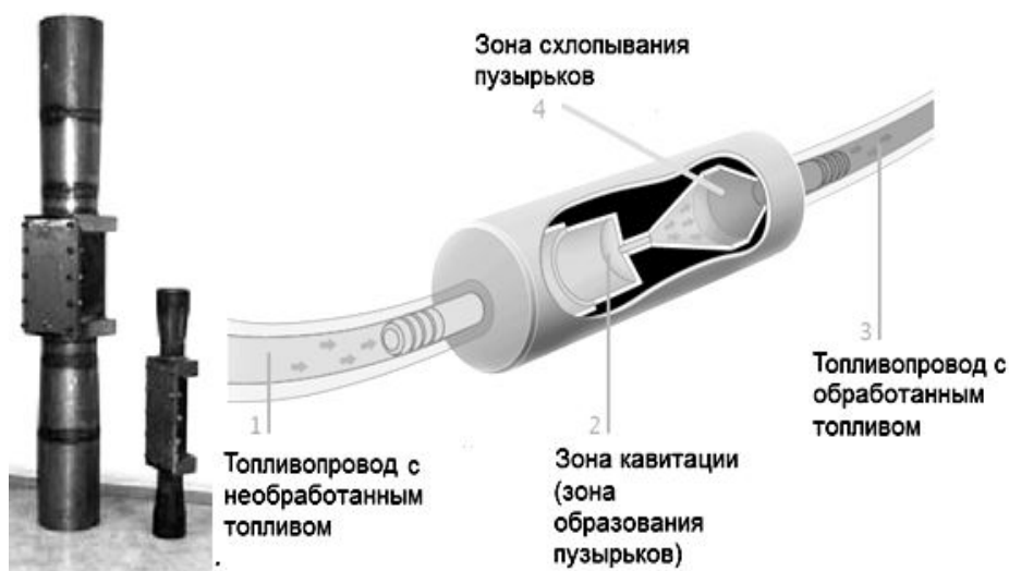
Рис.1 – Пассивный диспергатор и схема его работы
