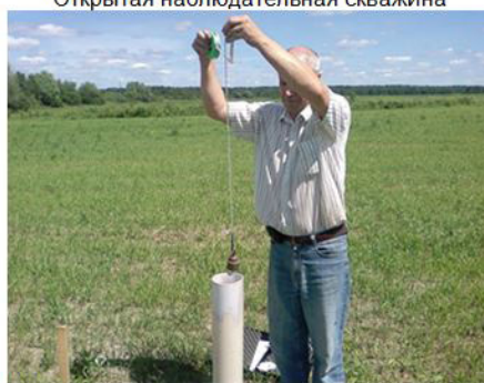
Измерение уровня грунтовых вод с помощью хлопущки
