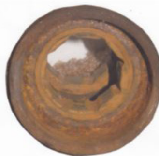
Рис.3 – Поверхности подшипника скольжения из специальной резины
