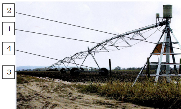
1 – трубопровод, 2 – неподвижная опора, 3 – самоходная тележка, 4 – щит управления Рис.1 – Общий вид дождевальной машины Кубань-ЛК1
