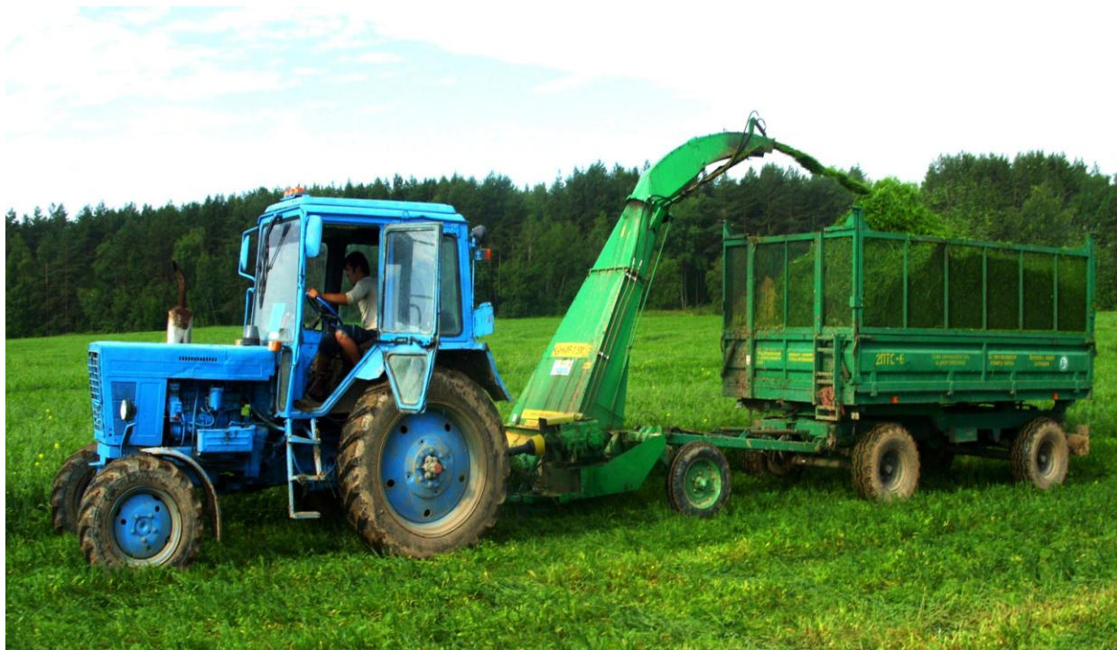
Рисунок 1.3 – Роторный комбайн КИР - 1,5
