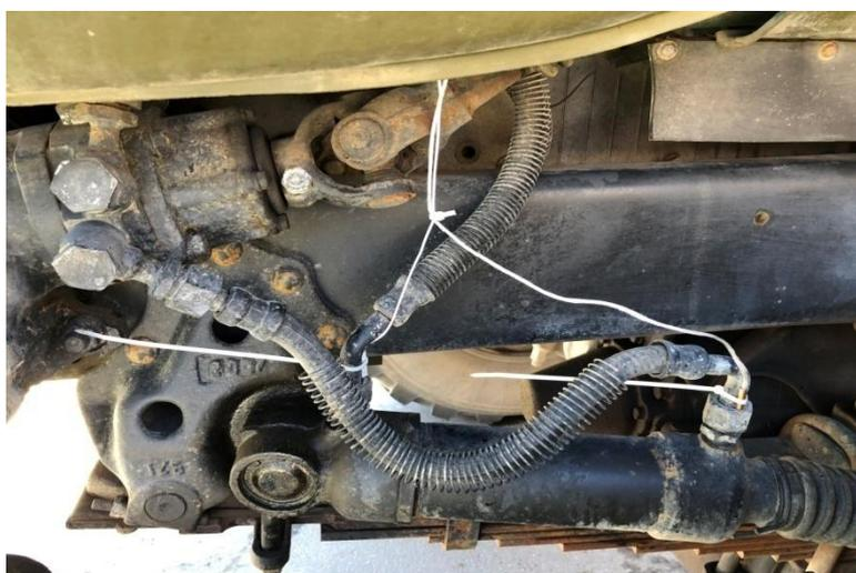
Рисунок 3.7 – Местаподсоединения термопар №2 и №3 к трубопроводам силового цилиндра
