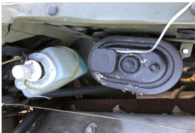
Рисунок 3.8 – Место измерения температуры рабочей жидкости в бачке насоса
