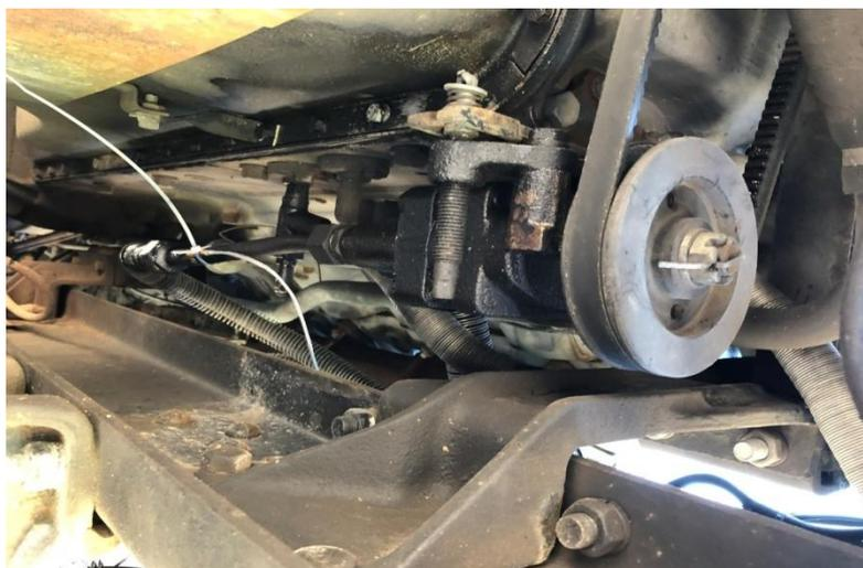
Рисунок 3.6 – Место подсоединения термопары к трубопроводу масляного насоса
