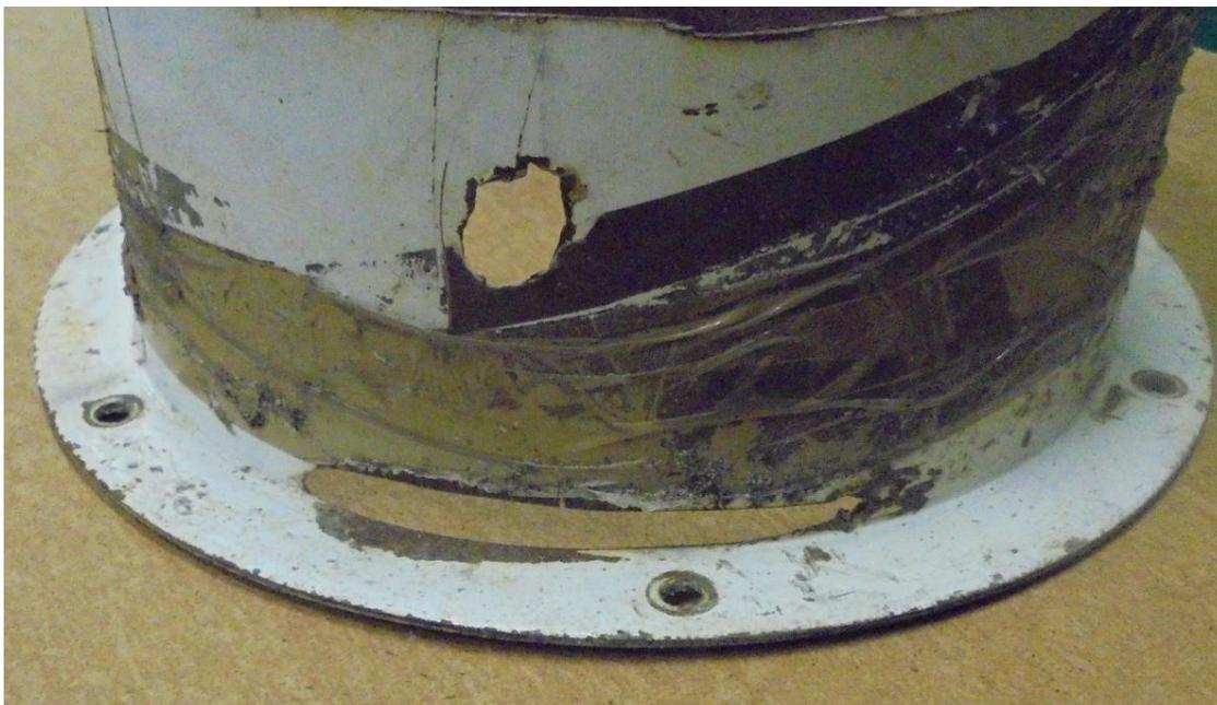
Рисунок 1.2 – Износ зернопровода в местах соединения участков
