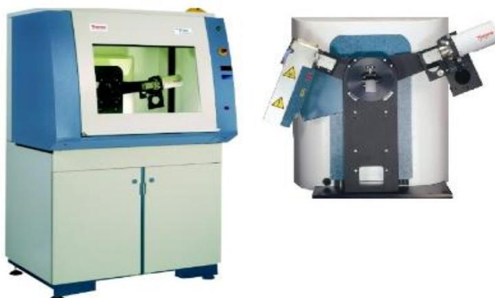
Рисунок 3.7 – Внешний вид рентгеновского дифрактометра ARL X'TRA
