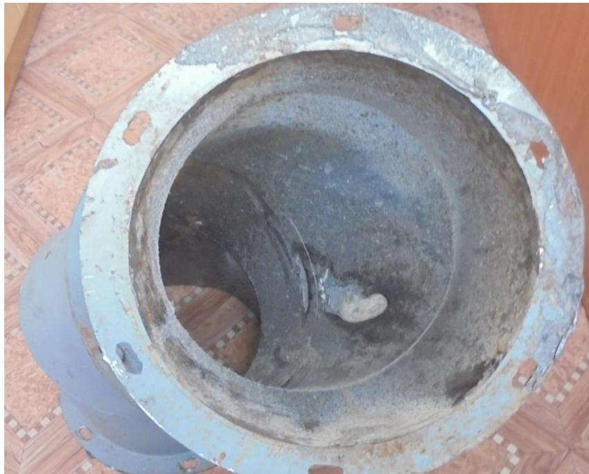
Рисунок 1.4 – Износ поворотного колена
