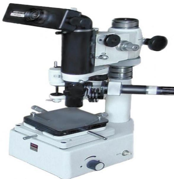
Рисунок 3.5 - Внешний вид микротвердомера ПМТ-3.
