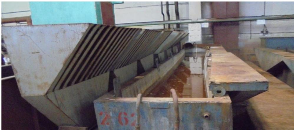
Рисунок 1.18 – Горизонтальное расположение ванны для покрытий деталей больших размеров
