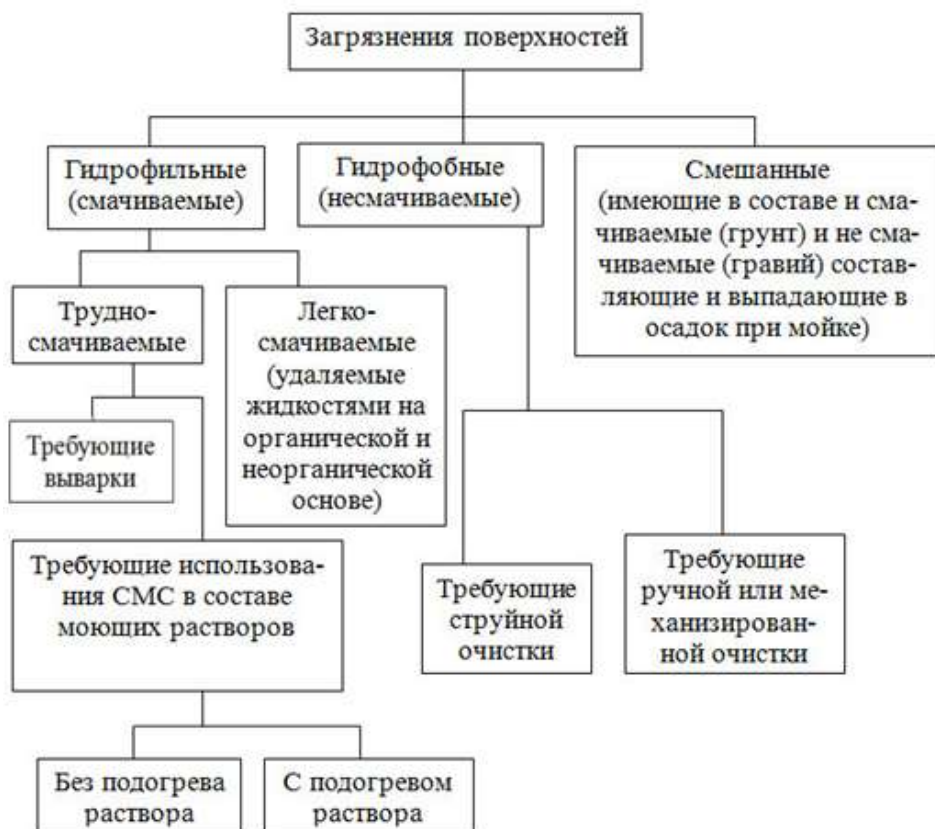
Рисунок 1 – Классификация загрязнений по их смачиваемости
