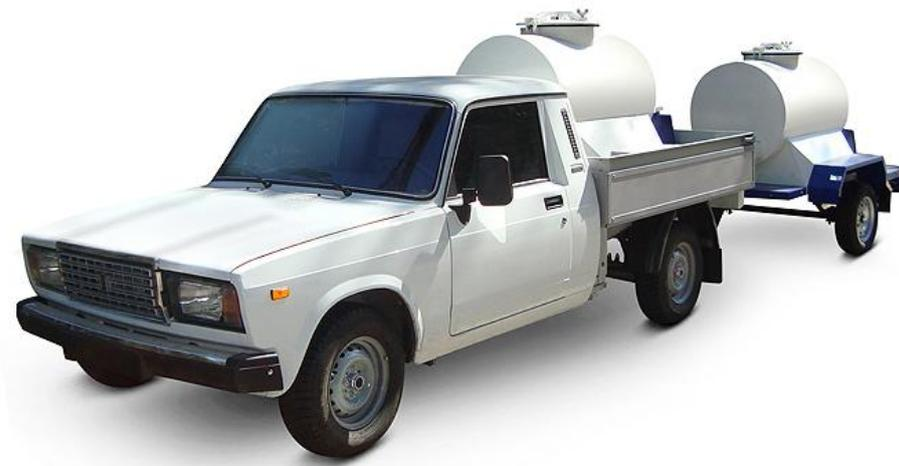
Рисунок 6.12 – Пикап-автомобиль ВИС-2349 «ГРАНТА» 4×2 бортовой цистерна с прицепом-цистерной
