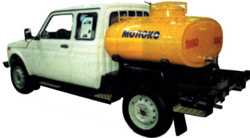
Рисунок 6.9 – Молоковоз ВИС-23464 на базе автомобиля ВАЗ 21213
