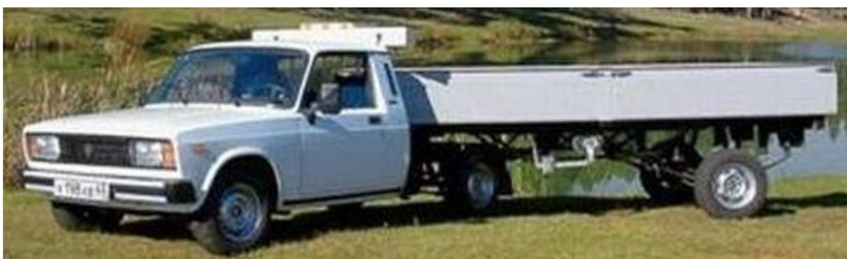
Рисунок 6.13 – Пикап-автомобиль ВИС-2349 «ГРАНТА» 4×2 бортовой для перевозки тюков
