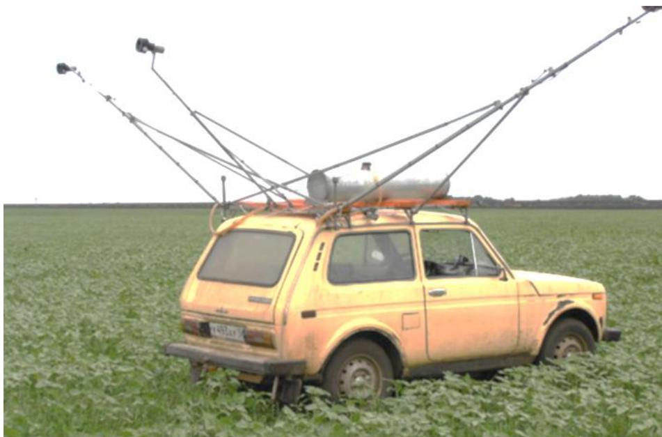
Рисунок 6.8 – Навесное оборудование на автомобиле ВАЗ-2121 «Нива» для опрыскивания полей (Патент РФ № 67402 «Агрегат для химической обработки посевов»)
