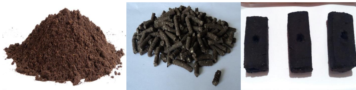
Рисунок 67 – Органический материал до и после прессования
