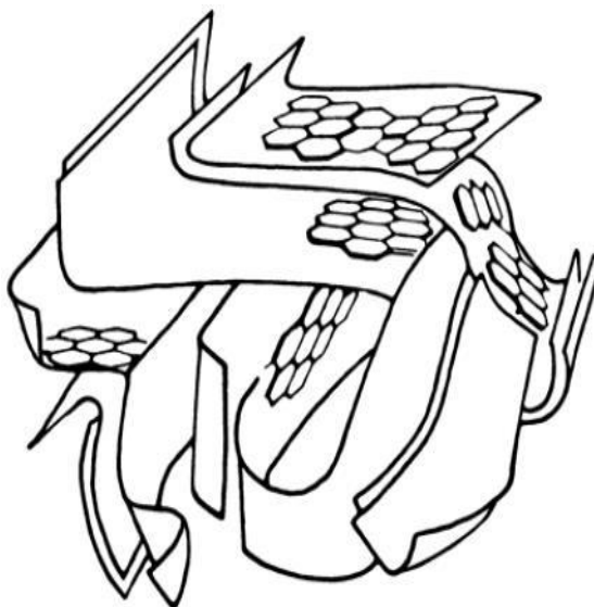
Рисунок 2.4 – Схематическое представление структуры активированного угля [52, 127, 128]
