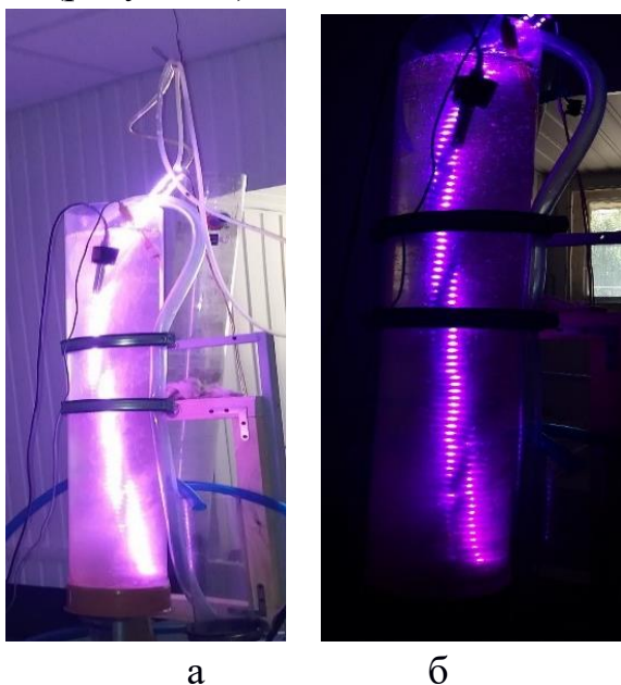
Рисунок 2 - Лабораторная модель (а - без культуры; б - с культурой) культиватора хлореллы с осветительно-аэрационным элементом.
