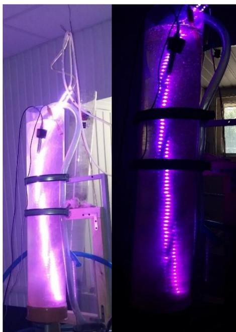
Рисунок 3.3 - Лабораторная модель культиватора хлореллы с осветительно-аэрационной установкой.
