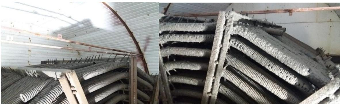
Рисунок 4.10 - Фильтр биологической очистки барабанного типа
