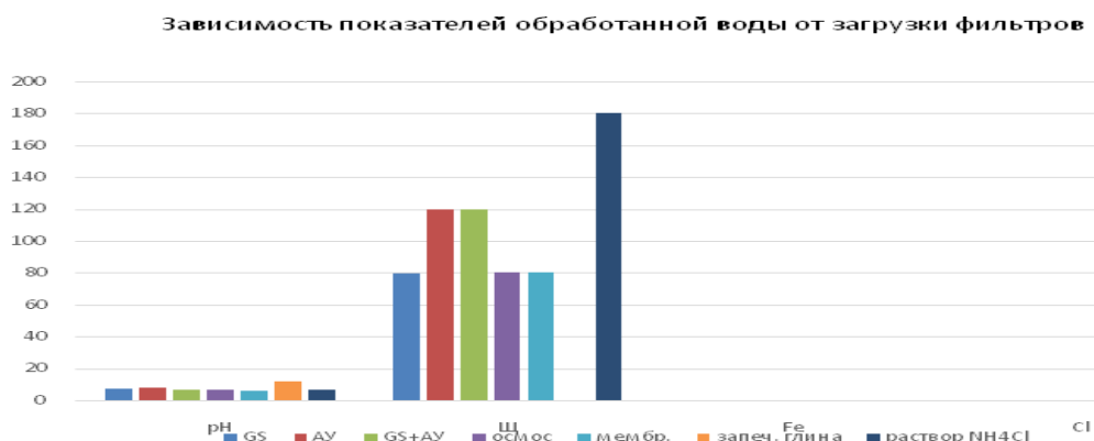
Рисунок 4 - Показатели очищенных подземных вод на установке с различными фильтрующими перегородками
