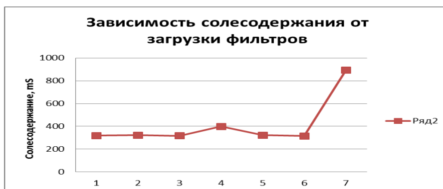
Рисунок 3 - Солесодержание очищенной подземной воды в зависимости от режима обработки на установке: 1-мембрана; 2-осмос; 3-резервуар с добавлением NaCl; 4-зеленый песок Greend Sand; 5-зеленый песок Greend Sand и активированный уголь АУ; 6-активированный уголь; 7-загрузка из термообработанной глины.
