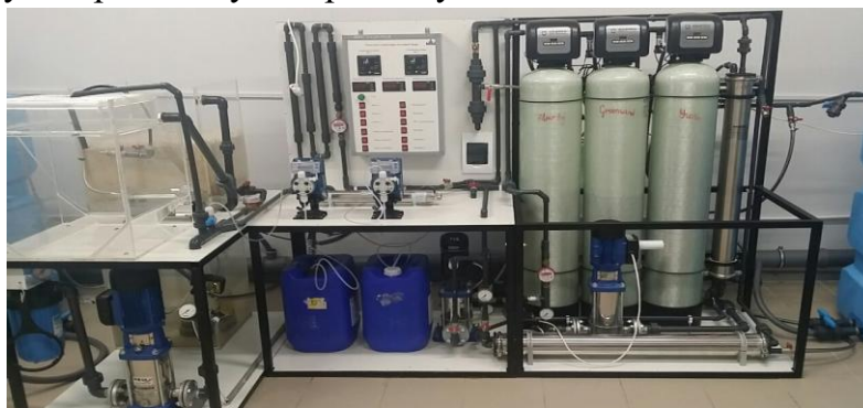
Рисунок 2 - Опытно-производственная установка очистки подземных вод в динамическом режиме.
