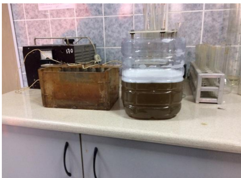
Рисунок 3.9 – Лабораторная установка электрокоагуляции, исходная вода после мойки шерсти с применением СПАВ.
