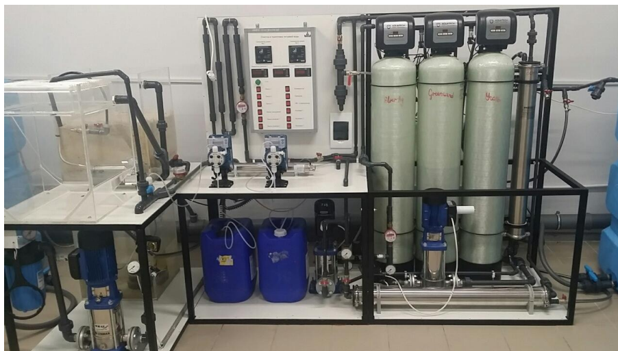
Рисунок 3.2 Экспериментальная установка очистки подземных вод в динамическом режиме [48]
