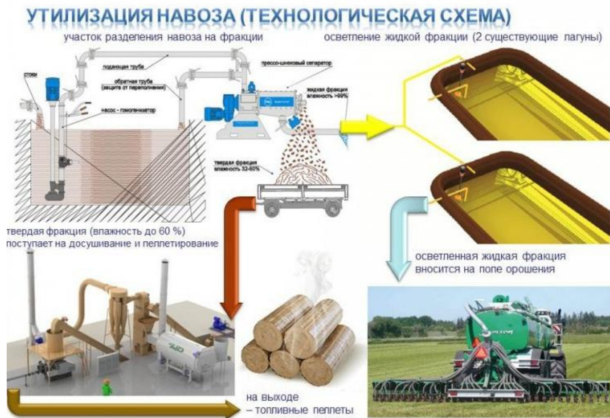
Рисунок 1.2 Принципиальная технологическая схема утилизации навоза [28]
