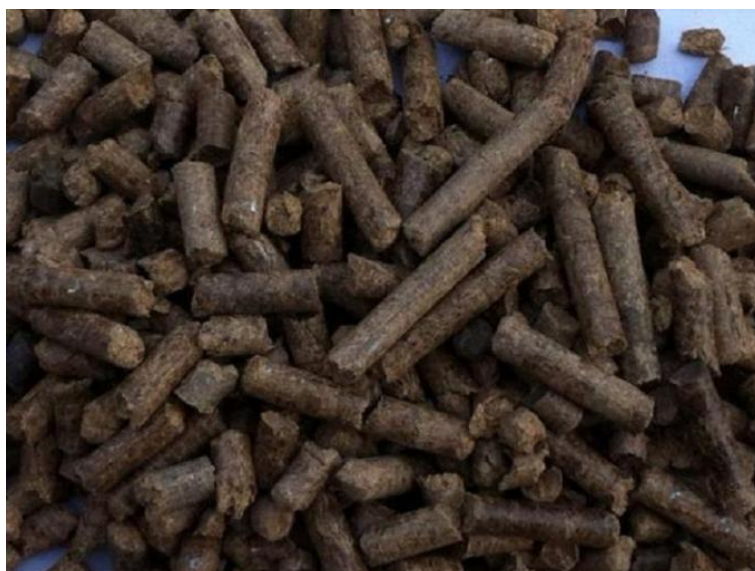
Рисунок 1.3 - Топливные элементы (пеллеты) из овечьего навоза
