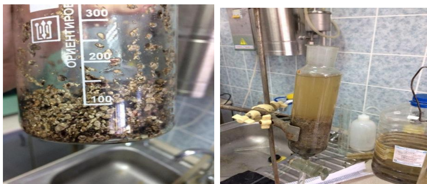
Рис. 3.12 Обработка очищенной электрокоагуляцией воды отстаиванием воды ПОШ сорбцией на «СВЕРАД»
