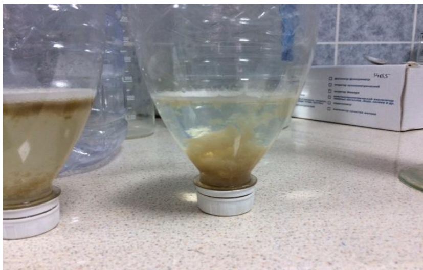
Рисунок 3. 10 – Визуальное качество очищенной электрокоагуляцией воды после 7.5 минут обработки и 15 минут отстаивания
