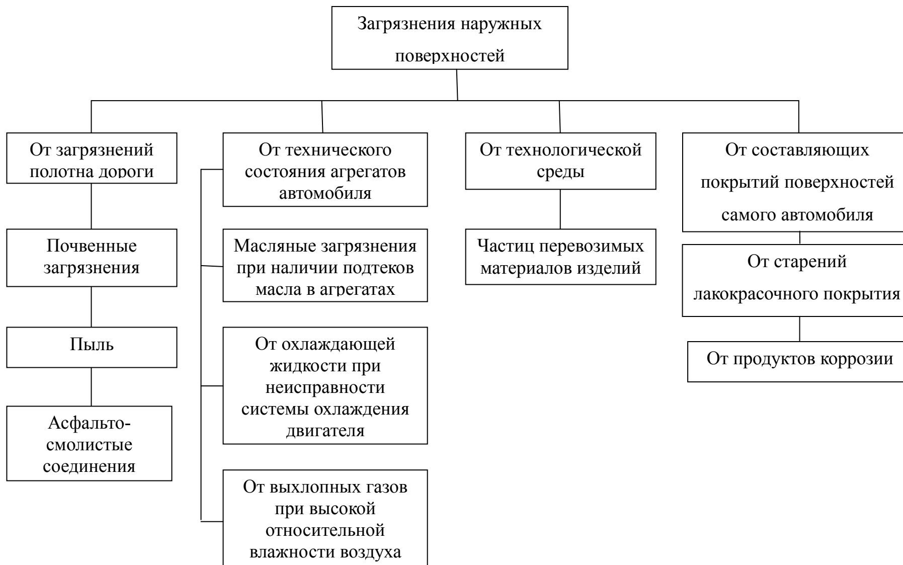
Рисунок 1.8 – Классификация загрязнений наружных поверхностей автомобилей [112]
