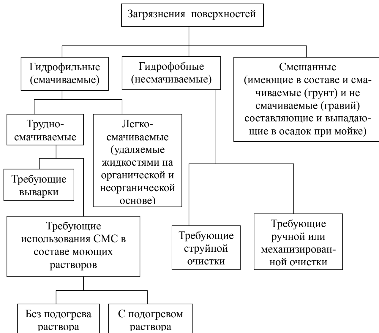
Рисунок 1.7 – Классификация загрязнений по их смачиваемости [112]
