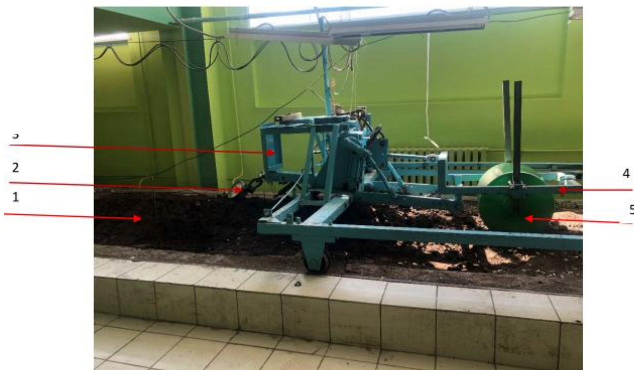
1 – почвенный канал; 2 – тяговый динамометр; 3 – подвижная тележка; 4 – навеска; 5 – каток.
