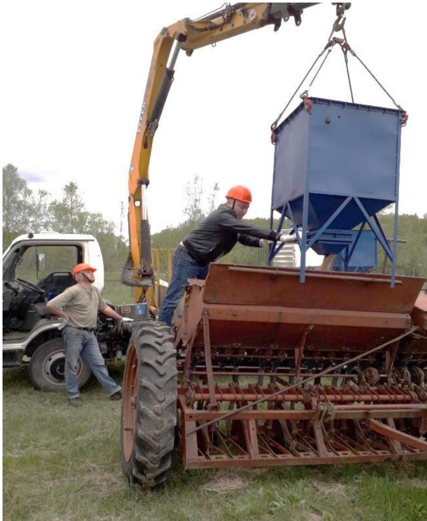
Рисунок 4.12 - Загрузка сеялки СЗ-3.6 из герметичного металлического контейнера
