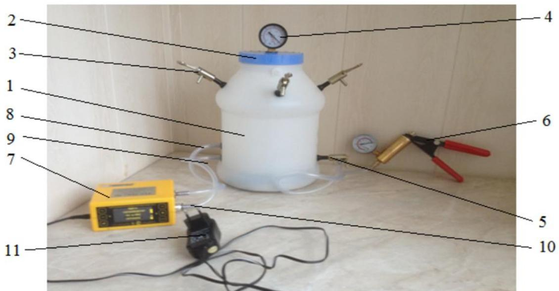
1 - бак для хранения зерна; 2 - герметичная крышка бака; 3 - атмосферный золотник с вентилем; 4 - контрольный вакуумметр GSGJ 27100; 5 - вакуумный золотник с вентилем; 6 - вакуумный насос MHR – A998A с вакуумметром; 7 – газосигнализатор комбинированный многокомпонентный портативный СК-2; 8 – входной штуцер с фильтром для забора проб газа из контейнера; 9 - выходной штуцер для отвода газовой пробы в контейнер; 10 -воздушный фильтр, 11 – зарядное устройство.
