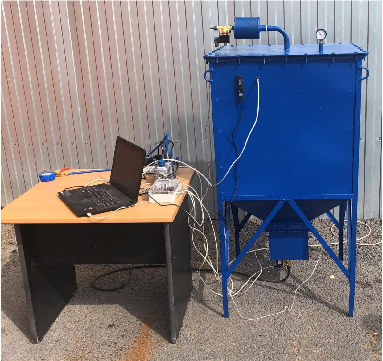
Рисунок 2.2 - Общий вид герметичного контейнер для хранения семенного зерна в разреженной атмосфере
