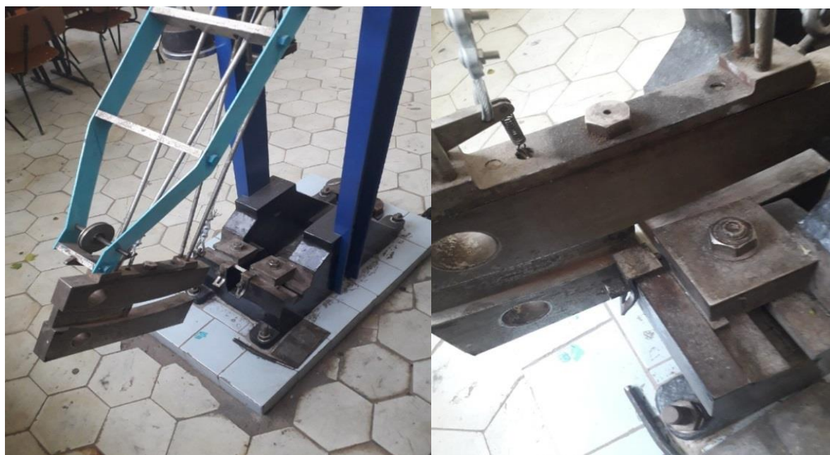
Рисунок 4.4 – Падение маятника с высоты 0,20 м
