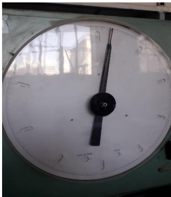
Рисунок 4.2 – Общий вид шкалы разрывной машины Р-50 при испытаниях на разрыв образцов второго типа
