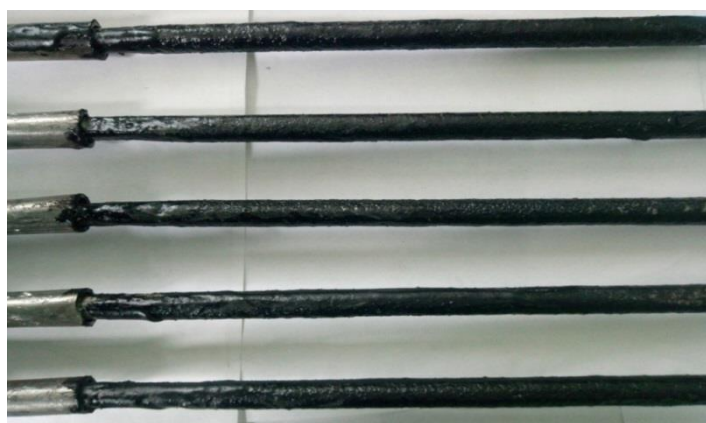
Рисунок 3.1 – Вид композитных прутков покрытых гидроизоляционной мастикой
