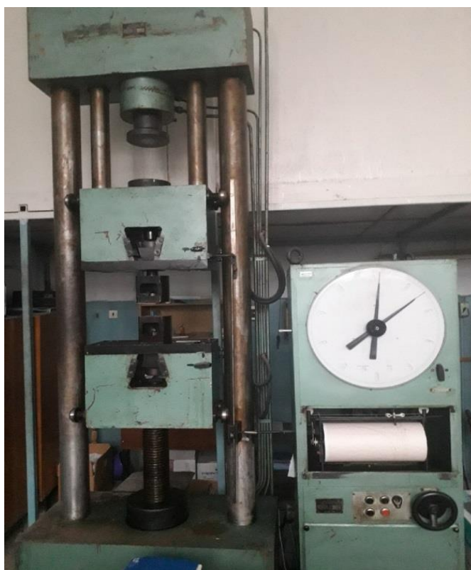
Рисунок 3.7 – Общий вид разрывной машины Р-50 при проведении испытаний на разрыв
