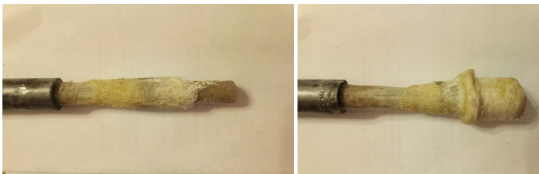
Рисунок 4.1 – Вид образца первого типа после испытания на разрыв
