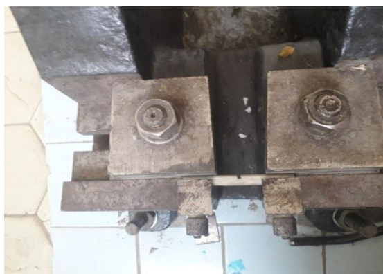
Рисунок 3.11 – Фиксация экспериментального образца для исследования на ударную вязкость
