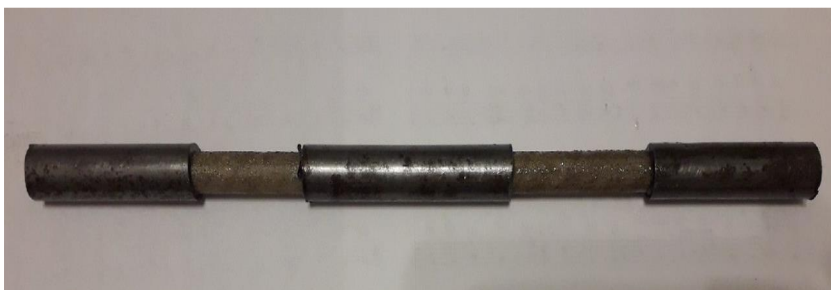
Рисунок 3.6 – Экспериментальный образец №2 для исследований на разрыв композитных прутков
