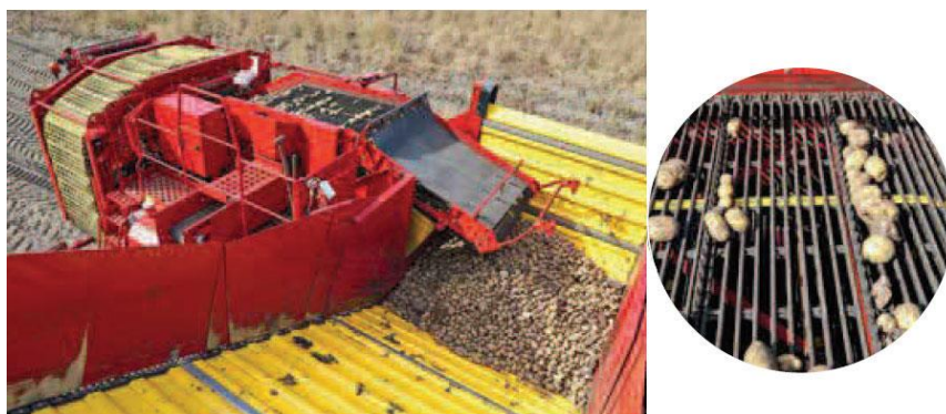
Рисунок 1.5 – Общий вид инспекционного стола самоходного картофелеуборочного комбайна «Grimme» VARITRON 270 PLATINUM TERRA TRAC
