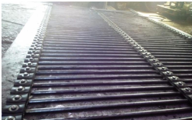
Рисунок 1.22 – Общий вид пруткового полотна с резиновыми ремнями
