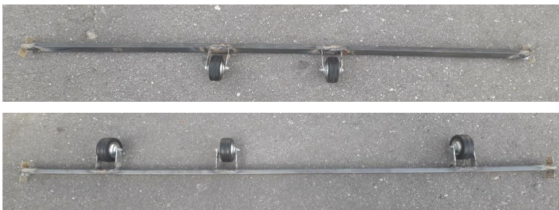
Рисунок 3.4 – Профильная труба профильного сечения с закрепленными на ней роликами интенсификаторами
