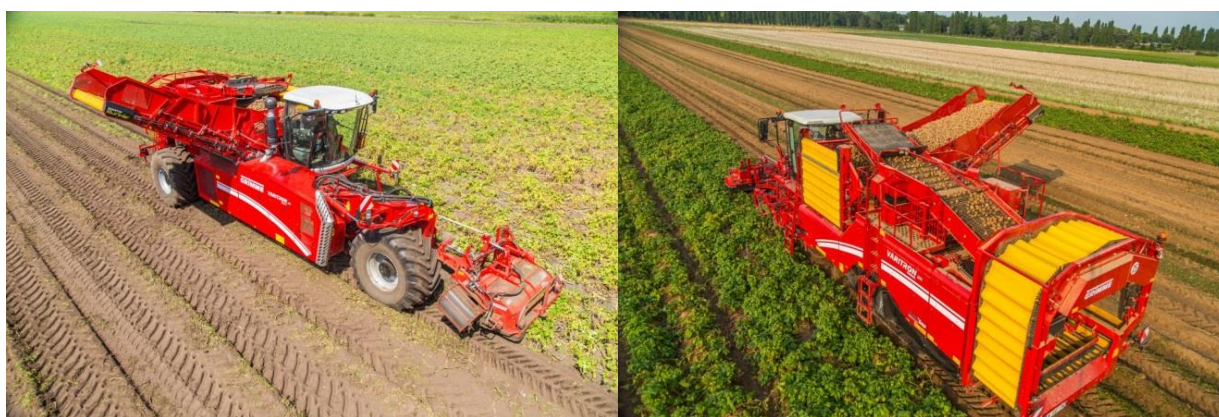
Рисунок 1.4 – Общий вид самоходного картофелеуборочного комбайна «Grimme» VARITRON 270 PLATINUM TERRA TRAC
