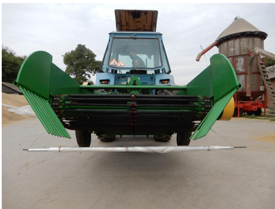
Рисунок 3.15 – Крепления пленки к модернизированному картофелекопателю КТН-2В для определения качества работы
