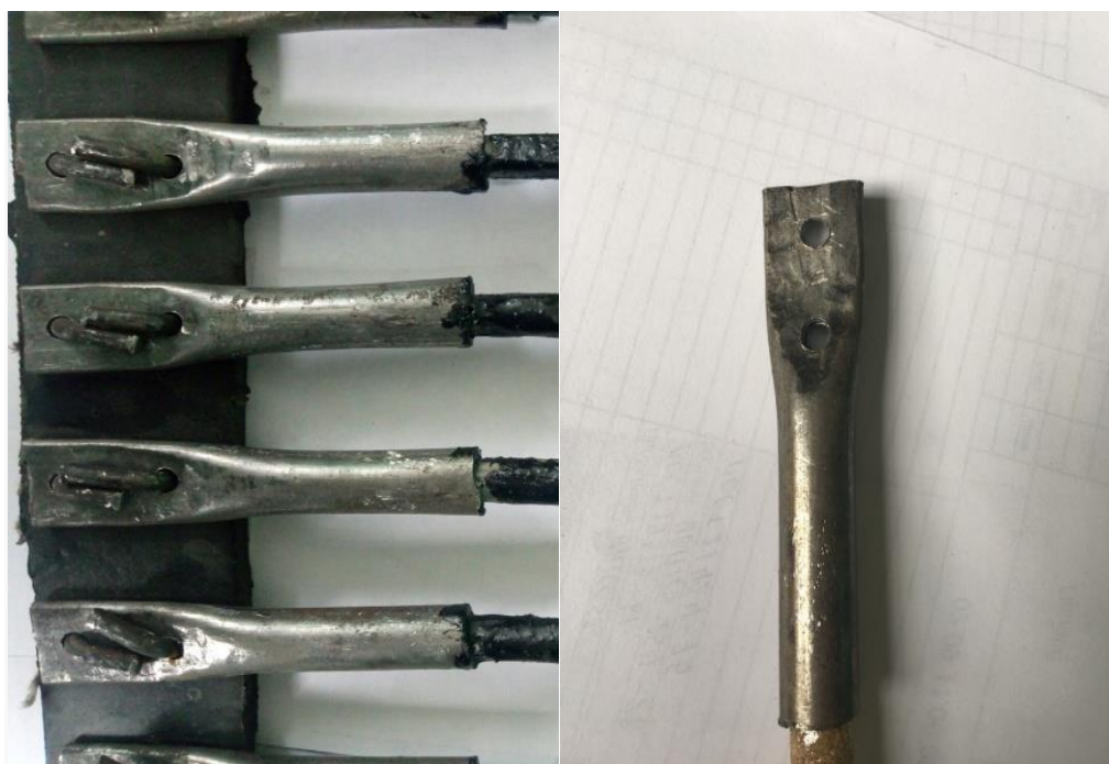
Рисунок 3.2 - Общий вид крепления композитных прутков к резино-тканевым ремням металлическими «замками»
