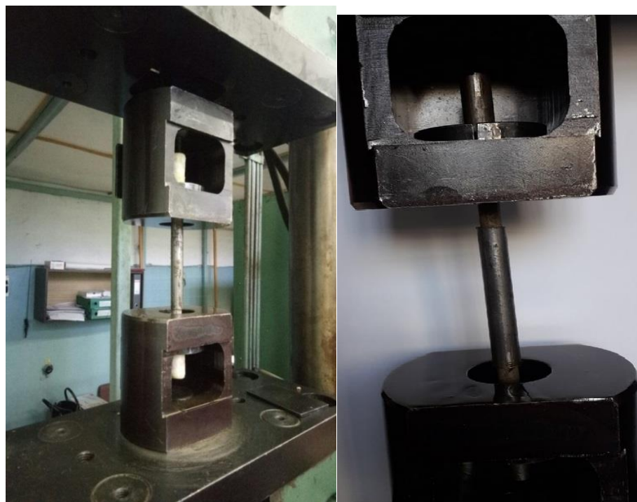
Рисунок 3.8 – Проведение эксперимента на разрыв соединения композитных прутков с металлическими замками
