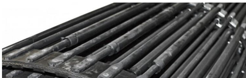
Рисунок 1.25 – Полотно сепарирующего элеватора с прутками покрытыми мягкими ПВХ трубками
