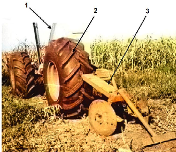
1-тележка ходовой системы; 2-колёсный движитель; 3-заравниватель колеи
