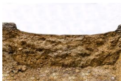
Рисунок 11 - Общий вид колее от ходовой системы ДМ «Кубань-ЛК1» при ее заравнивании - а, б - в разрезе
