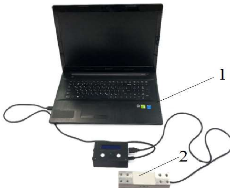
1 – компьютер; 2 – тензометрическое звено ходовой системы
