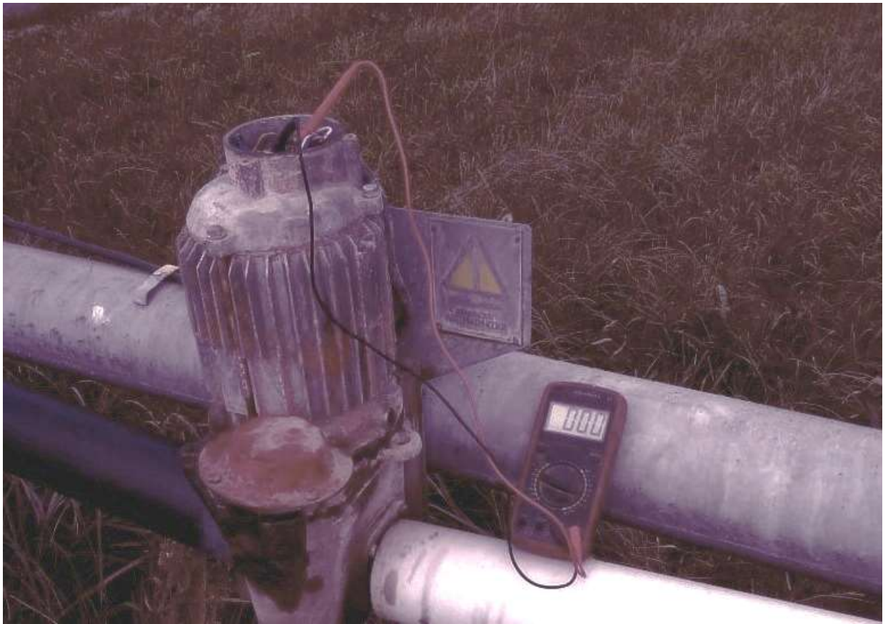
Рисунок 3.11. Общий вид приборов при оценке затрат мощности на перекатывание мотор-редуктором тележки ДМ «Кубань-ЛК1»
