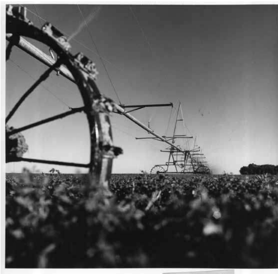
Рисунок 1.1. Широкозахватная дождевальная машина Valley 1060 производства фирмы Valmont Industries
