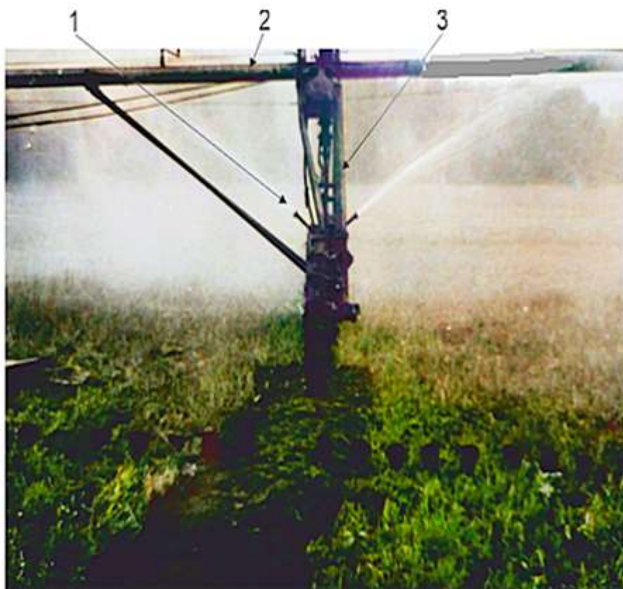
Рисунок 1.15. Схема выноса дождевальньх аппаратов на ДМ «Фрегат»
