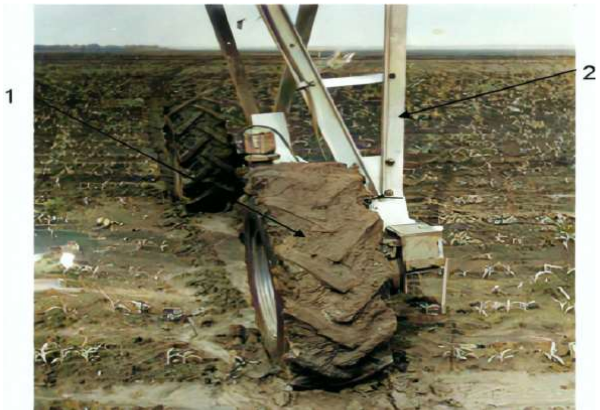
1 – пневматическая шина; 2 – рама тележки
