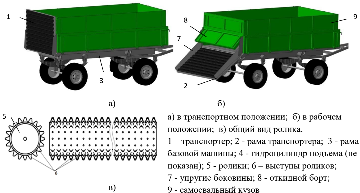
Рисунок 4 - Самосвальный кузов ТГА с навесным перегрузочным устройством (патент РФ на П.М. №161488)
