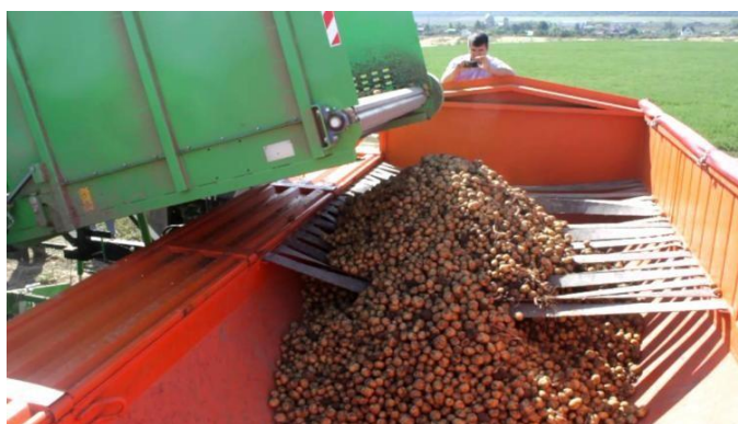
Рисунок 1.6 – Процесс загрузки кузова ТС с устройством для гашения энергии падения клубней
