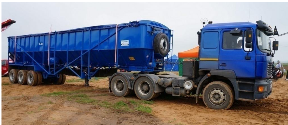
Рисунок 1.9 – Полуприцеп Тонар – 95235 с донным транспортером для разгрузки клубней [116]
