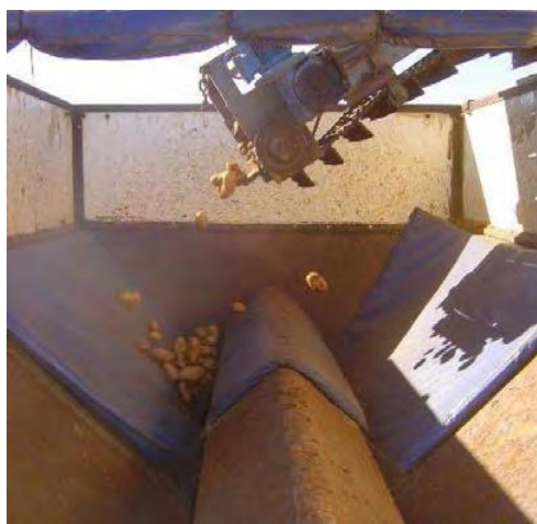
Рисунок 1.11 - Покрытие демпфирующим материалом защитного козырька донного транспортера
