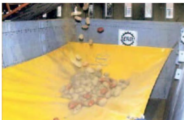
Рисунок 1.5 - Полотняный гаситель энергии падающих клубней
