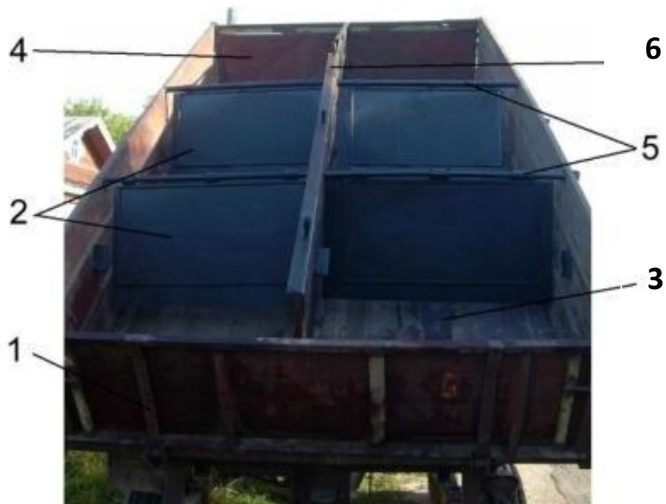
1 – откидной борт; 2 – поперечные перегородки; 3 – дно кузова ТС; 4 – передний неподвижный борт самосвального кузова; 5 – оси вращения поперечных перегородок; продольная неподвижная перегородка. Рисунок 1.22 –Общий вид опытного образца самосвального кузова ТС [59]
