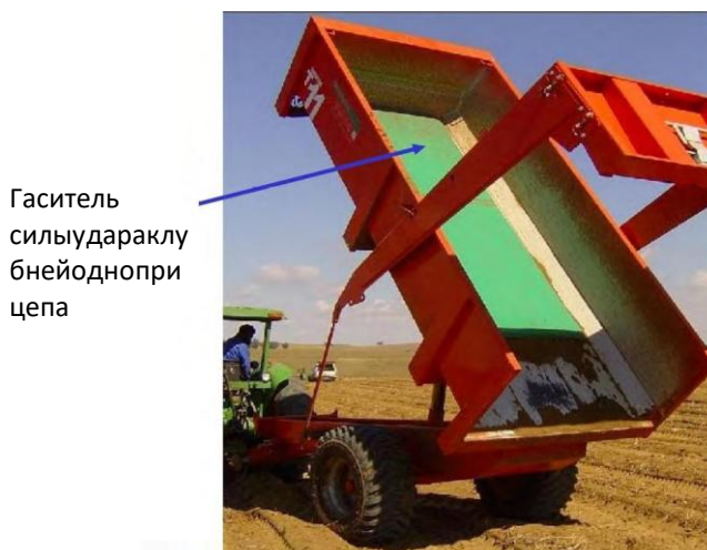
Рисунок 1.3 – Устройство для гашения энергии падения клубней в кузов самосвального полуприцепа
