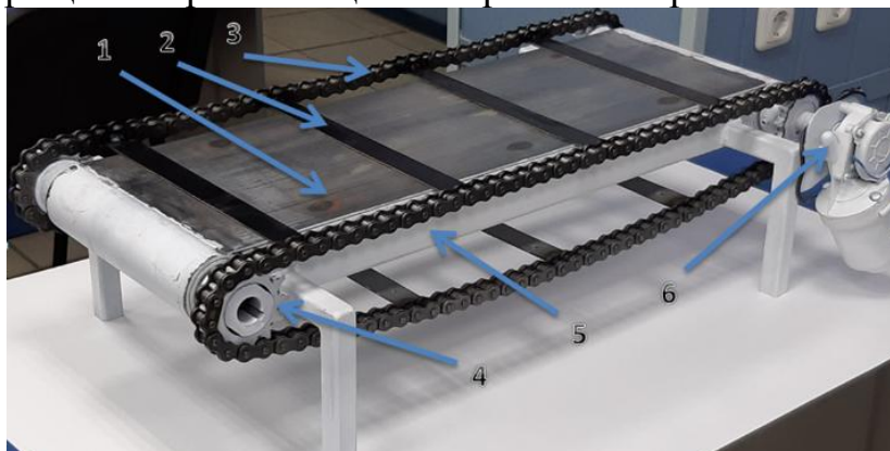
Рисунок 7 – Экспериментальная лабораторная установка для исследования процесса очистки донья транспортёра свеклоуборочных машин от почвенных масс:
