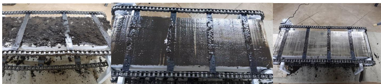
Рисунок 4.10 – Результаты очистки донья с фиксацией в различных временных интервалах с применением жидкости (воды)
