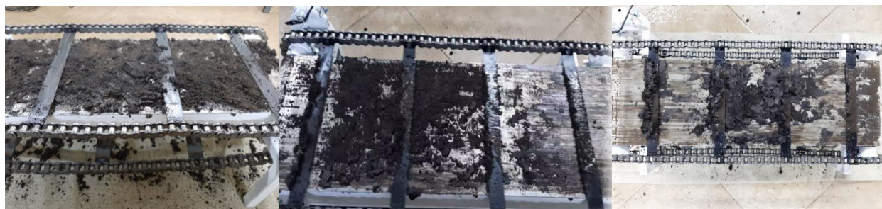
Рисунок 4.9 – Результаты очистки донья с фиксацией в различных временных интервалах без применения жидкости (воды)
