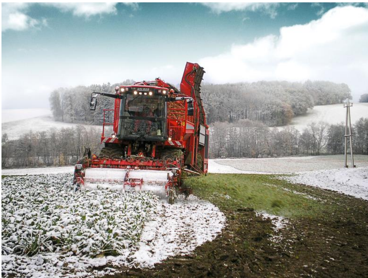
Рисунок 1.4 – Уборка сахарной свеклы комбайном Holmer.
