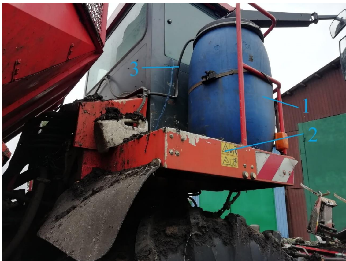
Рисунок 5.1 – Место размещения и крепления емкости с водой для обеспечения работы насосной станции и распылителей (на базе комбайна Holmer T2): 1 – ёмкость с водой; 2 – площадка комбайна; 3 – подающий шланг.
