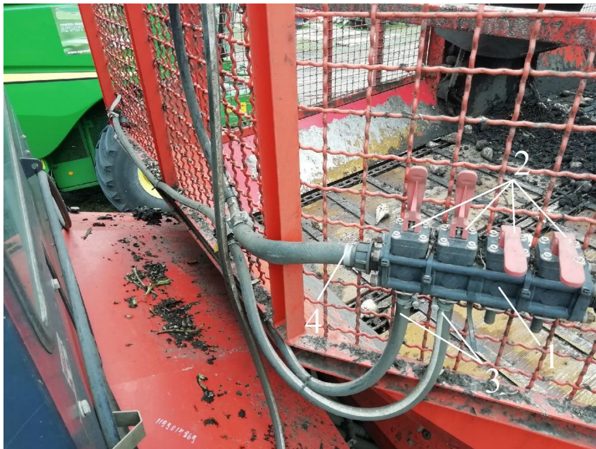
Рисунок 5.3 – Размещение гидрораспределителя на ограждении бункера свеклоуборочного комбайна: 1 – гидрораспределитель; 2 – регулирующие клапаны; 3 – питающие шланги форсунок; 4 – подающий шланг.
