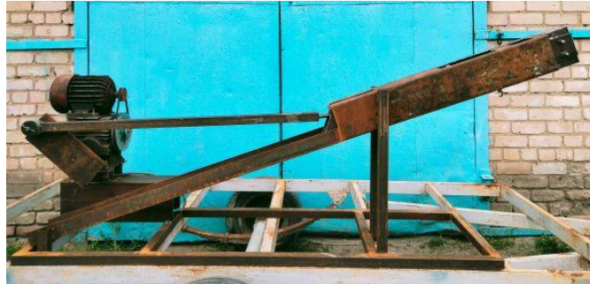
Рисунок 2 – Лабораторная установка измельчителя кормовой свёклы
