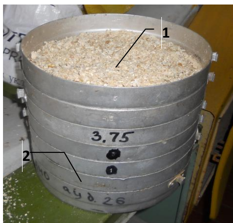
1 - древесные опилки; 2 - пофракционный контейнер
