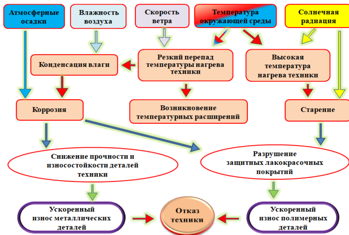
Рисунок 1.4 – Структурная схема влияния факторов окружающей среды на показатели надёжности техники
