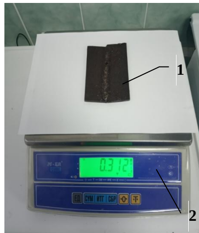
1 - образец; 2 - весы M-ER 326AF-6.1 LCD
