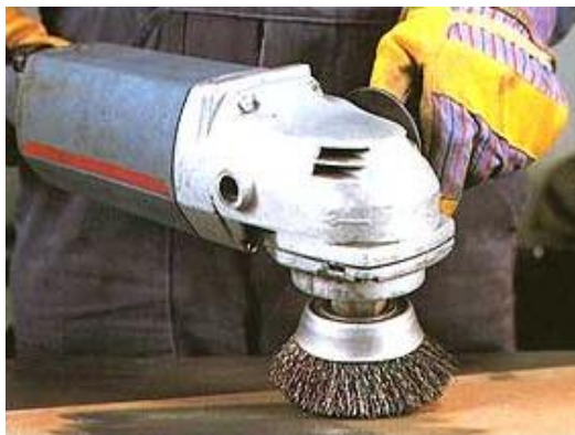
Рисунок 1.8 – Механизированная очистка с использованием проволочных щеток и абразивных дисков
