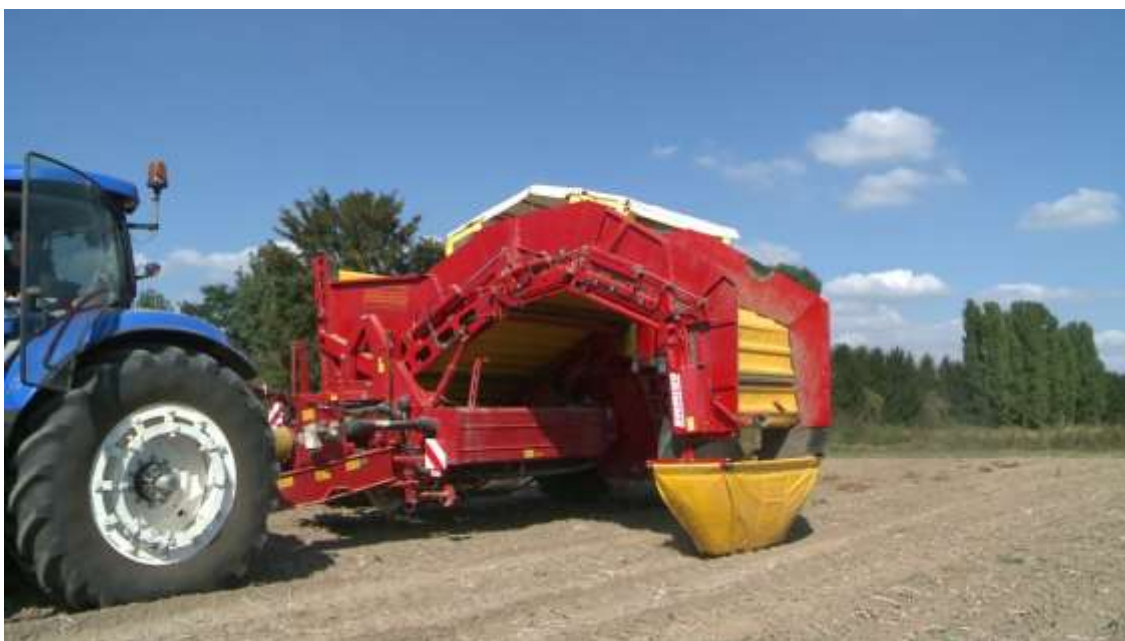
Рисунок 1.11 – Работа картофелеуборочной машины бункерного типа с системой «NonstopBunker»
