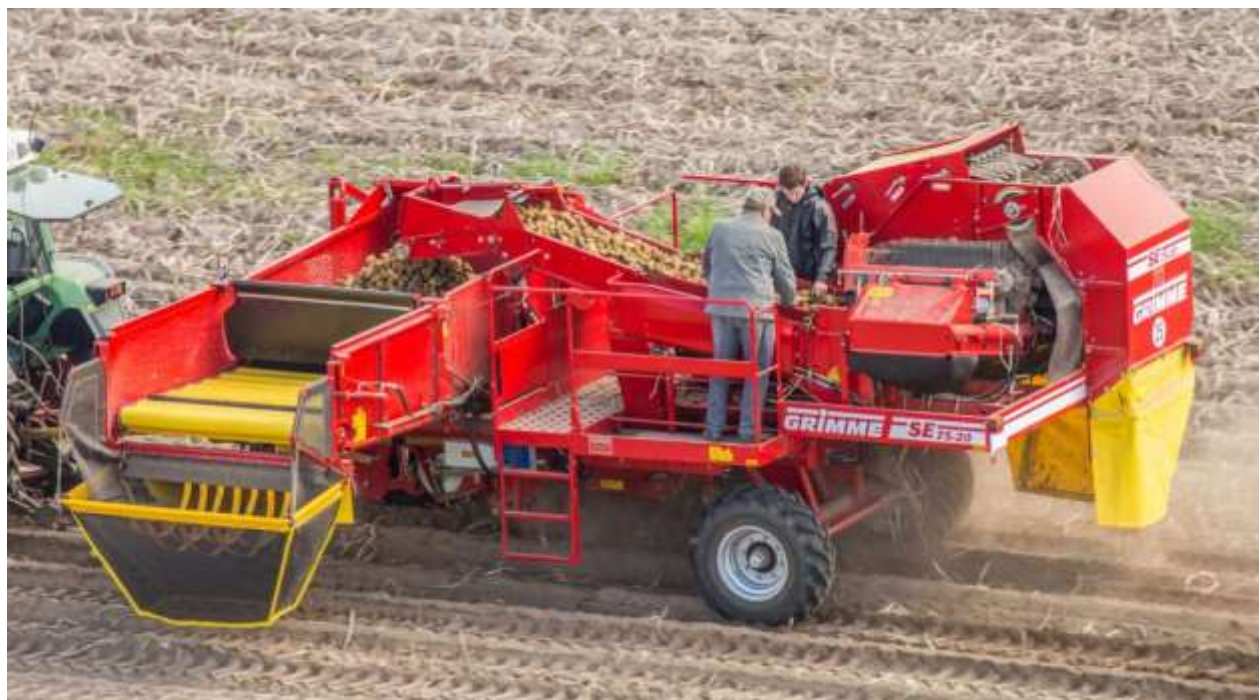
Рисунок 1.35 – Комбайн Grimme SE 75-20 с гасителем падения клубней
