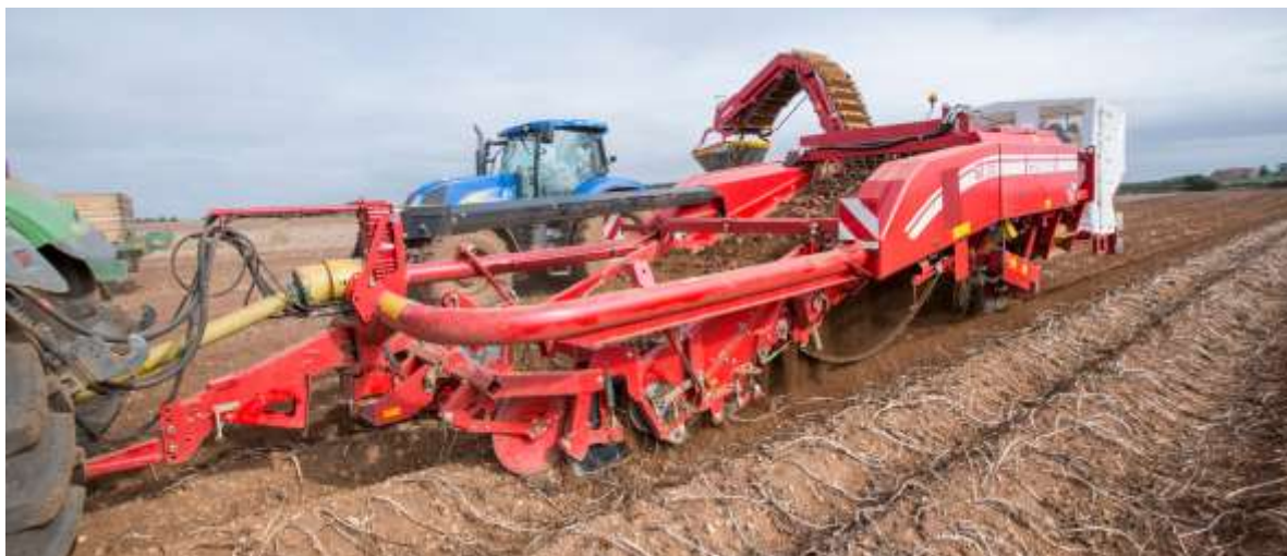
Рисунок 1.36 – Комбайн элеваторного типа Grimme GT 170 с гасителем падения клубней
