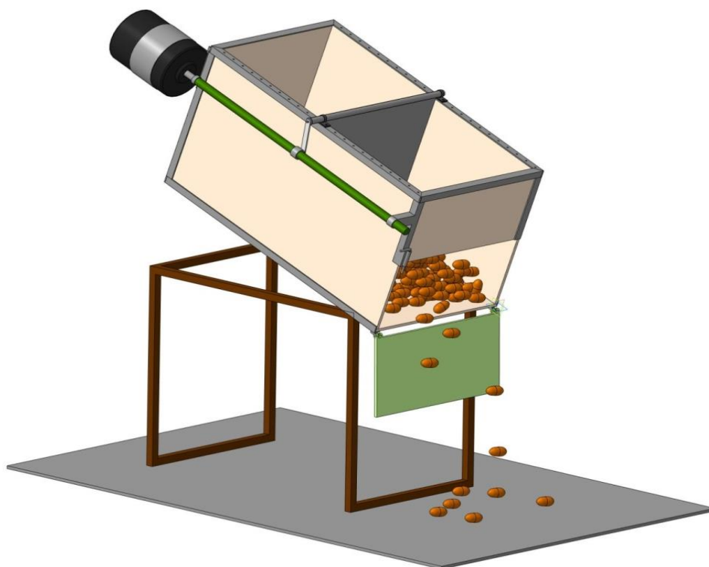
Рисунок 3.3 – Выгрузка клубней, расположенных у откидного борта бункера
