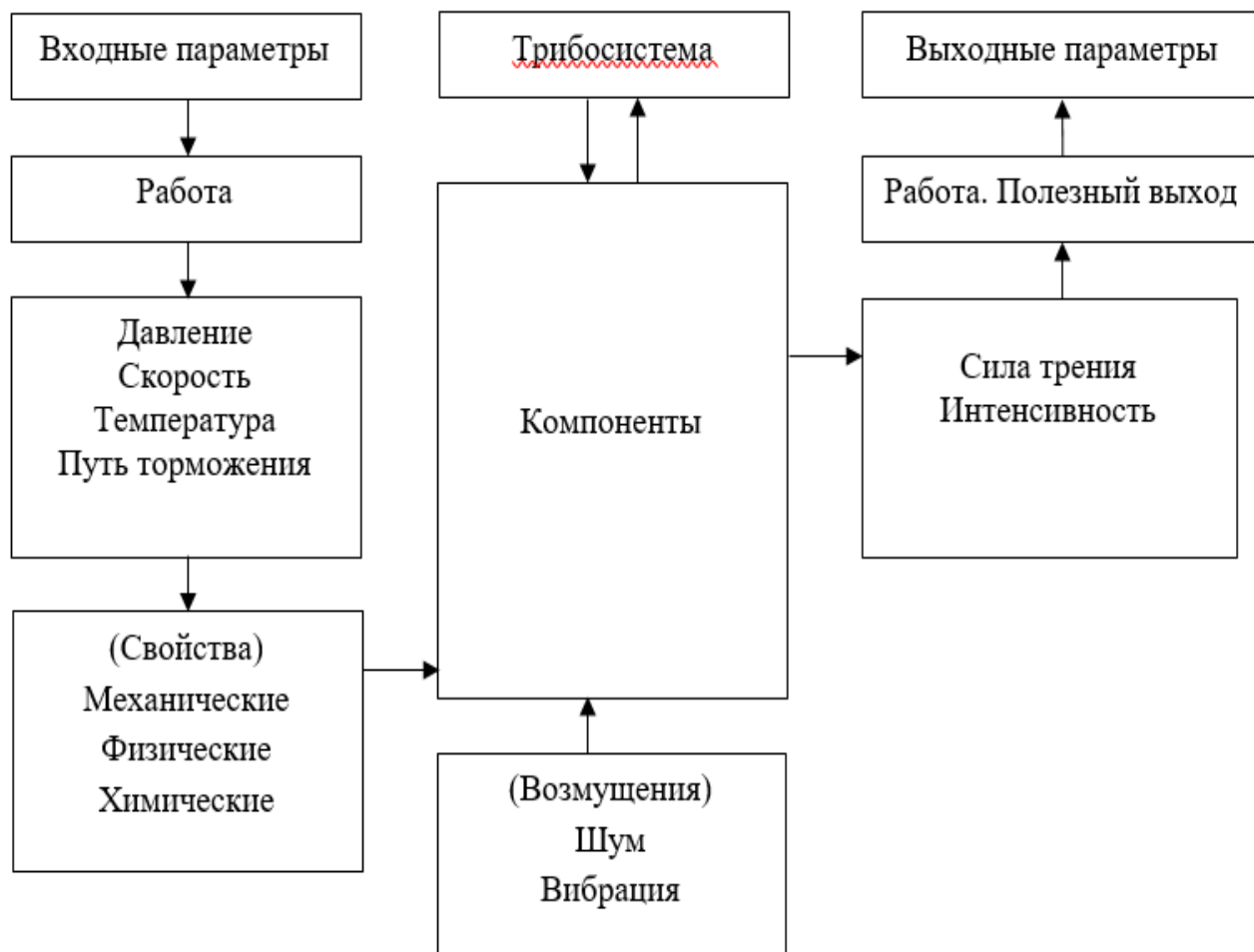
Рисунок А.2 – Трибосистема. Параметры изнашивания тормозной системы
