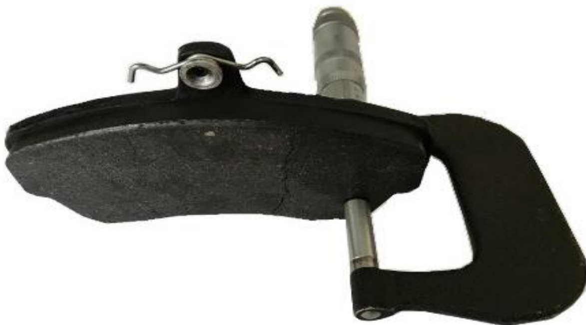
Рисунок 2.9 – Расположение микрометра относительно тормозной колодки
