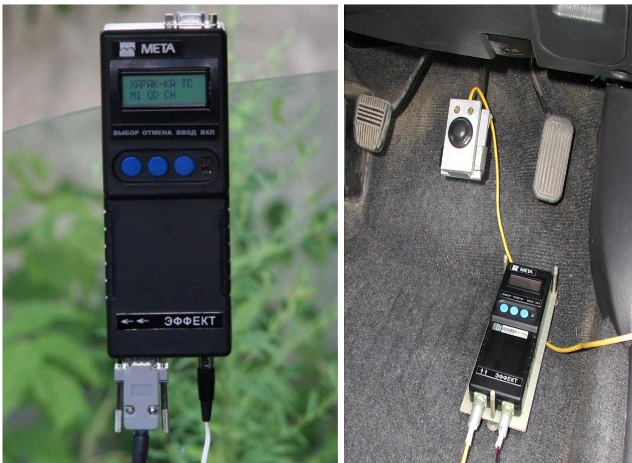
Рисунок 1.9 – Прибор «Эффект» для диагностирования тормозов методом ходовых испытаний
