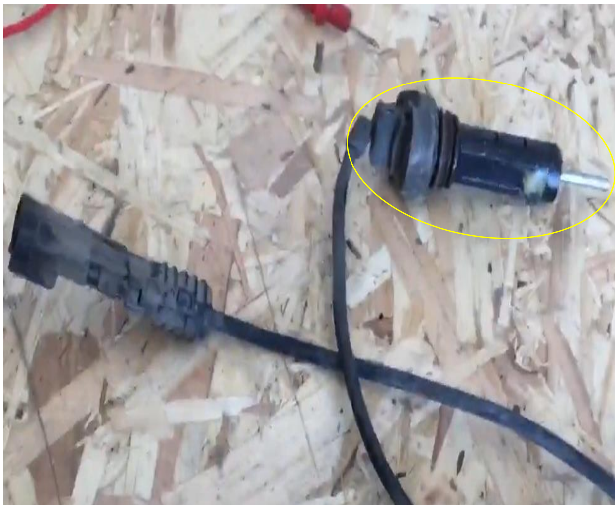
Рисунок 1.8 – Датчик износа колодки тормозной системы современного грузового транспортного средства
