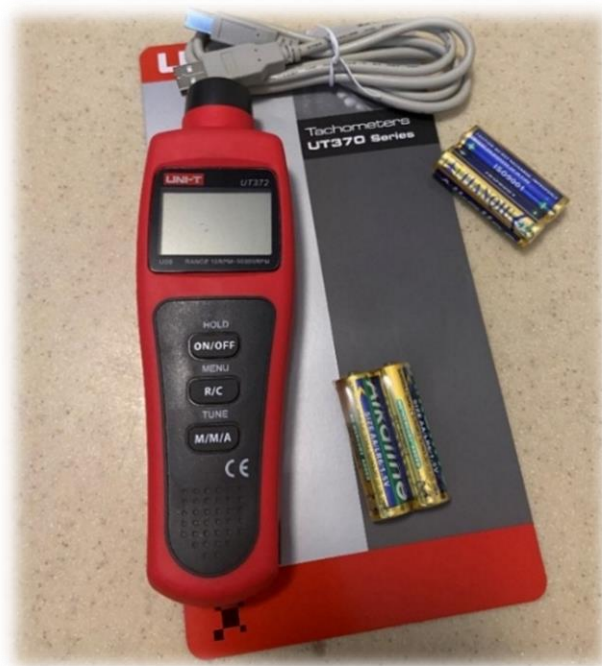
Рисунок 3.5 – Измерительный прибор числа оборотов колеса UNIT-372
