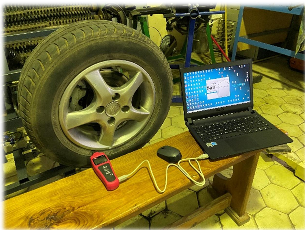
Рисунок 3.6 – Место расположения измерителя оборотов UNIT-372
