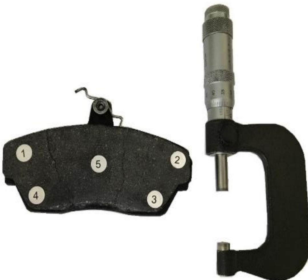
Рисунок 2.8 – Общий вид тормозной колодки с обозначением контрольных точек оценки износа:
