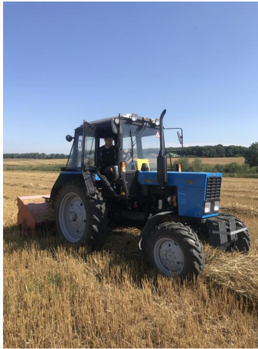
Рисунок 4.11 – Измельчитель – мульчировщик Kverneland FX-230 оборудованный разравнивающим устройством в агрегате с трактором МТЗ-82 во время хозяйственных испытаний.
