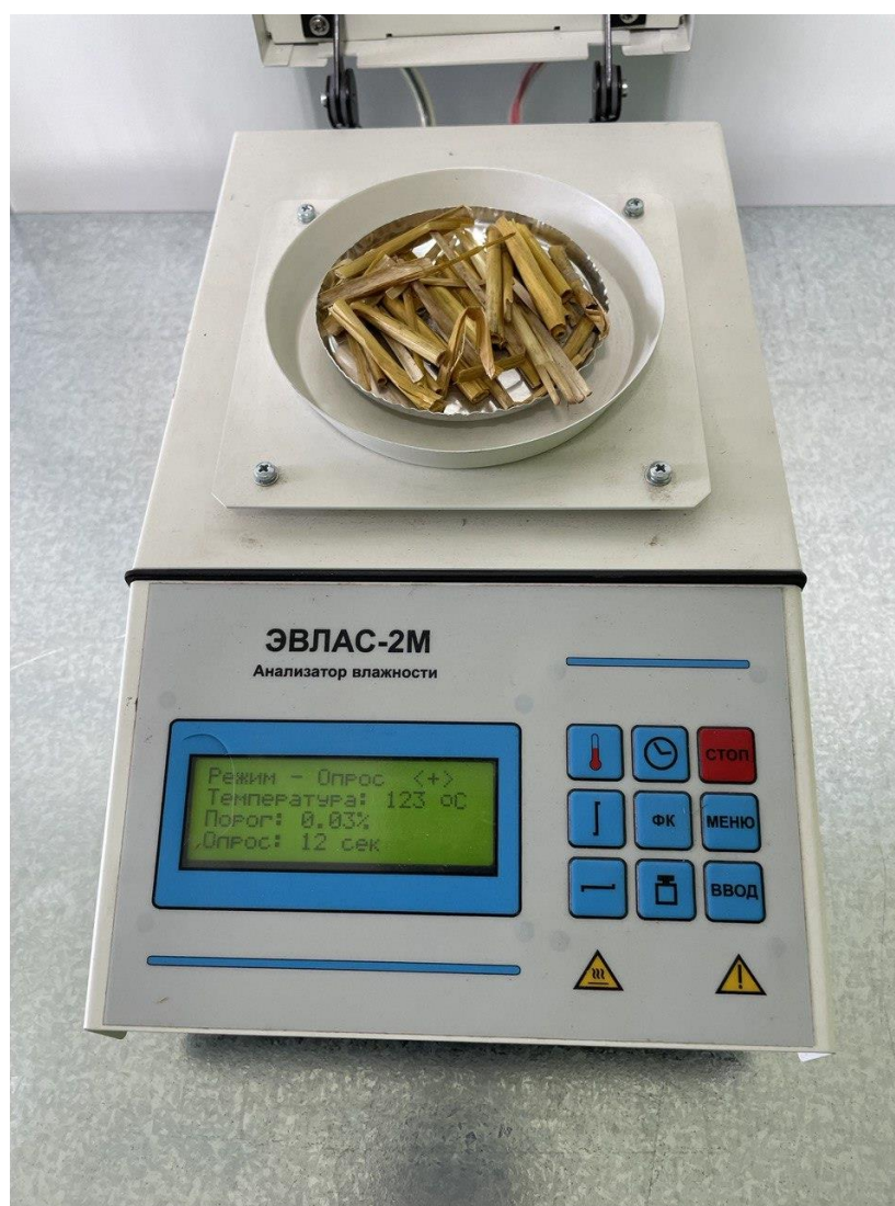
Рисунок 4.3 - Анализатор влажности ЭВЛАС-2М с пробой соломистой массы незерновой части урожая перед замером влажности
