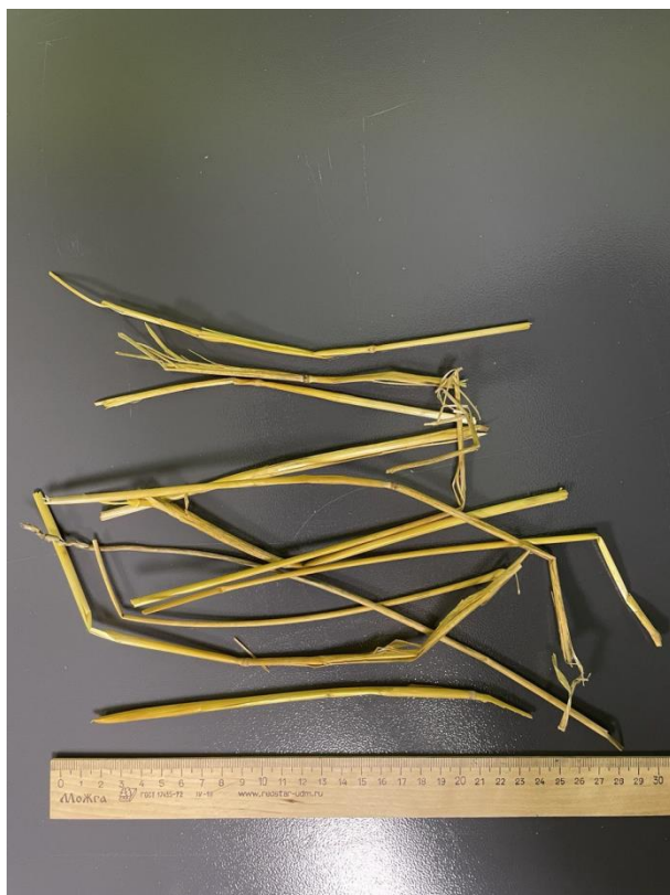
Рисунок 1.1 – Соломистая масса незерновой части урожая размерной фракции более 150 мм.
