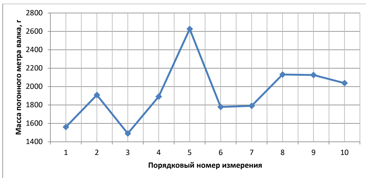
Рисунок 4.4 – График изменения массы погонного метра валка солоистой массы незерновой части урожая озимой пшеницы.
