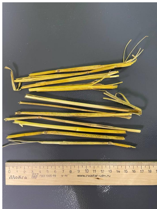
Рисунок 1.4 - Измельченная соломистая масса незерновой части размерной фракции 100 – 150 мм
