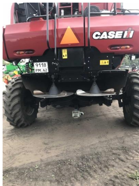
Рисунок 1.7 - Активная система разбрасывания измельченной соломы зерноуборочного комбайна CASE.
