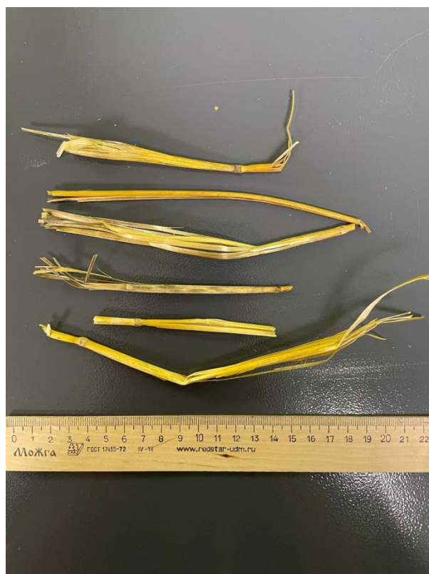
Рисунок 1.2 - Соломистая масса незерновой части с продольным расщеплением стеблей.
