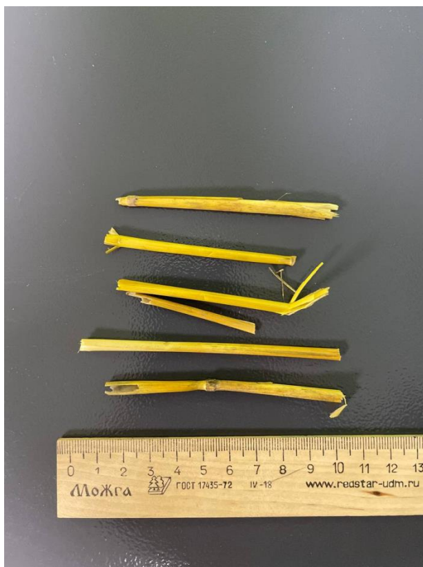
Рисунок 1.3 - Измельченная соломистая масса незерновой части размерной фракции 50 – 100 мм
