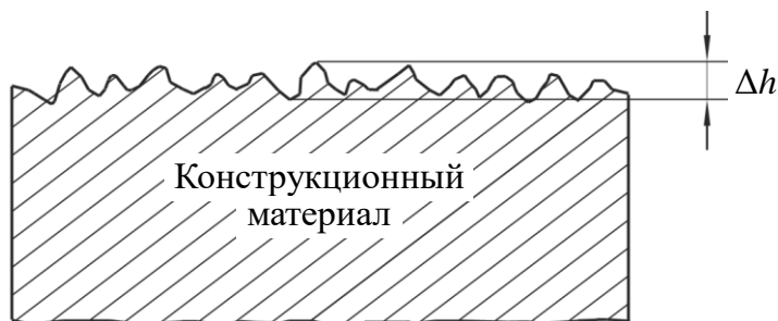
Рисунок 2.4 – Поперечное сечение поверхности: \Delta h – величина шероховатости
