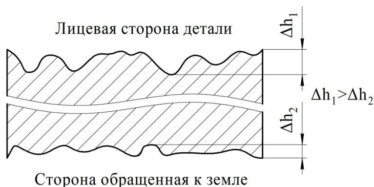
Рисунок 2.7 – Глубины поражения коррозией верхней и нижней поверхностей изделия
