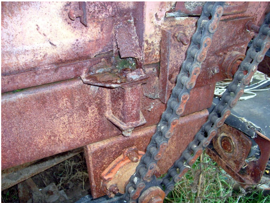
Рисунок 1.13 – Коррозионное поражение деталей втулочно-роликовых цепей привода кормораздатчика
