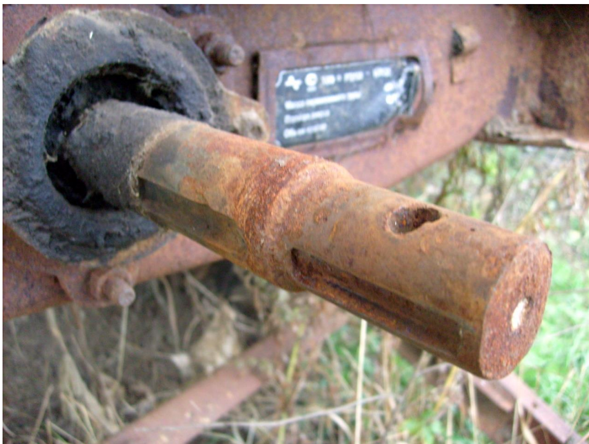
Рисунок 1.10 – Коррозия приводного вала раздатчика кормов
