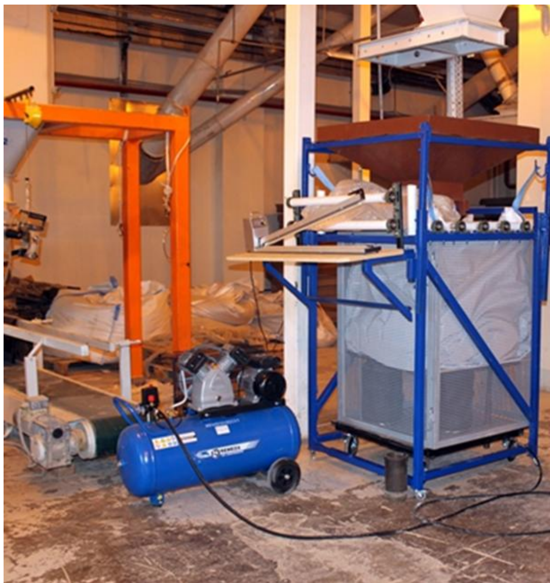
Рисунок 6 – Общий вид экспериментальной установки для упаковки комбикормов в мягкий контейнер с полиэтиленовым вкладышем
