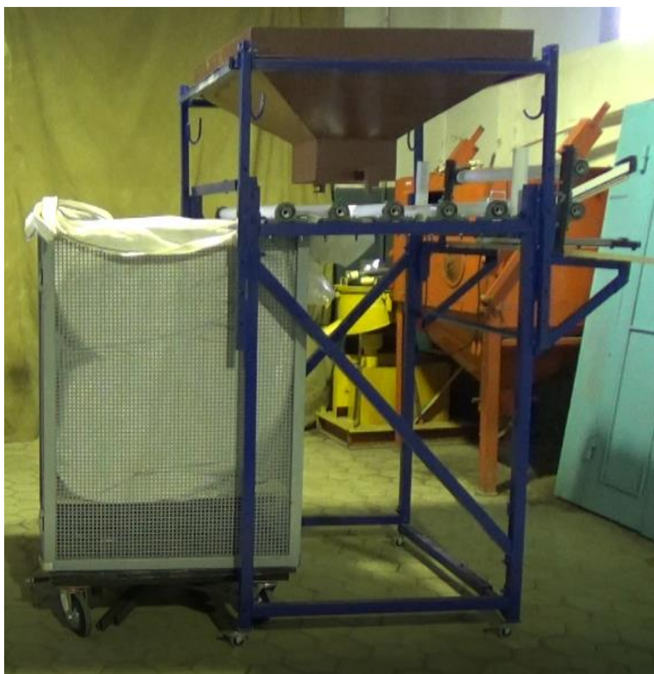
Рисунок 3.5 – Подготовка к загрузке комбикормом касеты с мягким контейнером
