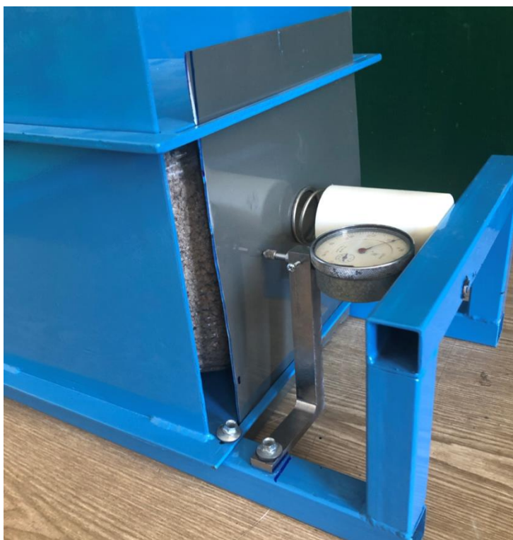
Рисунок 4.2 – Измерение деформации боковой стенки при сжатии комбикорма в полиэтиленовой упаковке
