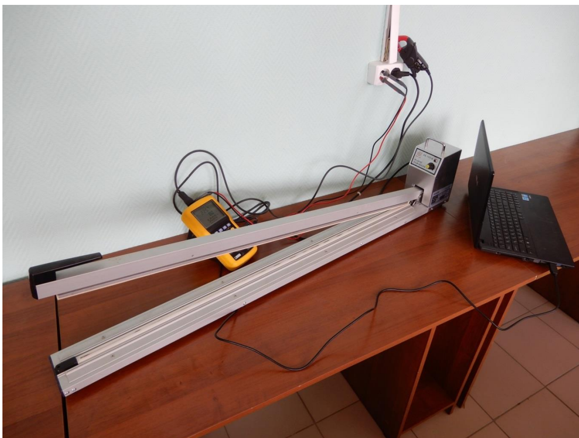
Рисунок 4.8 –Измерение потребляемой мощности электрического тока запаивателем при помощи анализатора качества электроэнергии CHAUVIN ARNOUX C.A 8220
