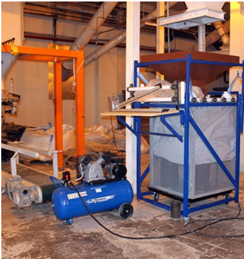
Рисунок 4.11 – Общий вид экспериментальной установки упаковки комбикормов в мягкий контейнер с полиэтиленовым вкладышем
