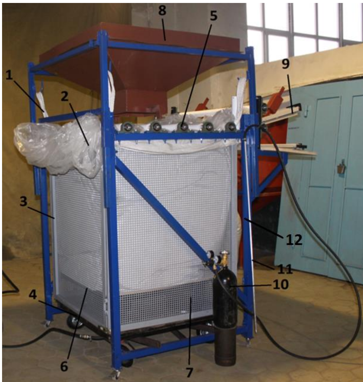
Рисунок 3.7 – Общий вид экспериментального устройства для упаковки комбикорма в среде углекислого газа
