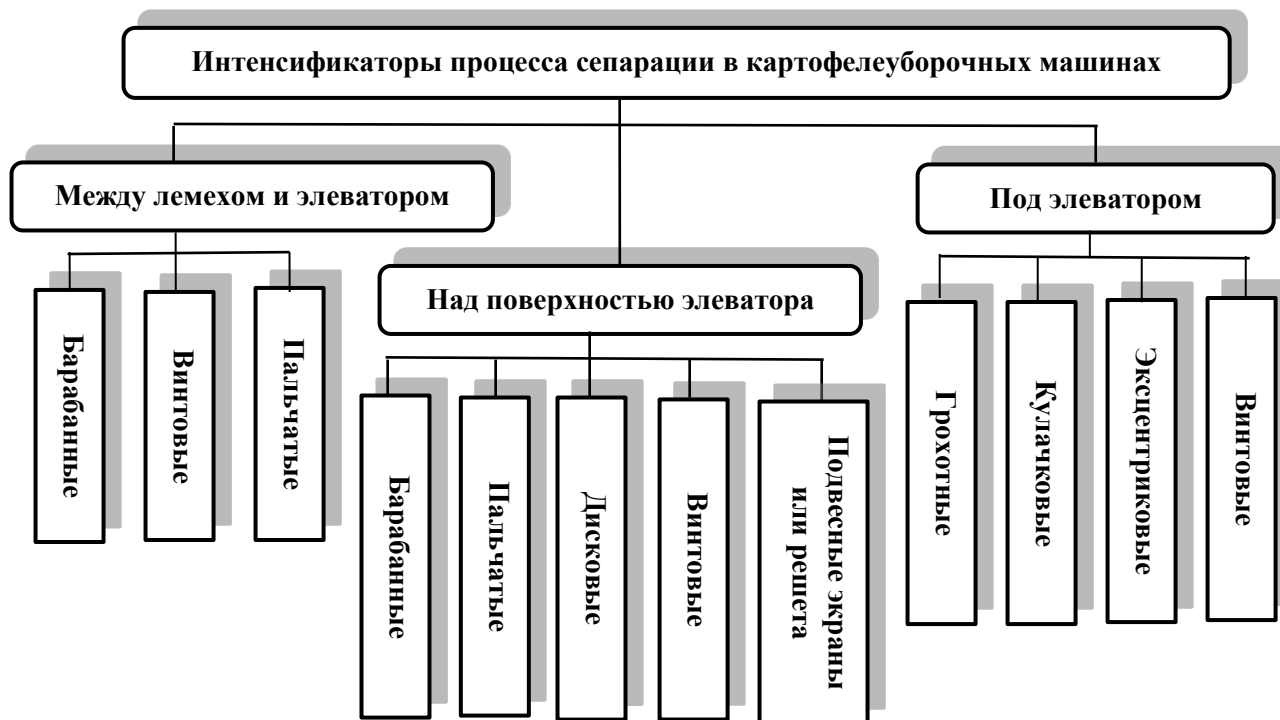
Рисунок 1.8 –Классификация интенсификаторов сепарации в картофелеуборочных машинах
