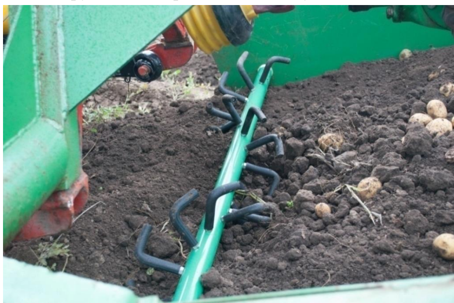
Рисунок 7 – Разработанный рыхлитель (патент РФ №213875)
