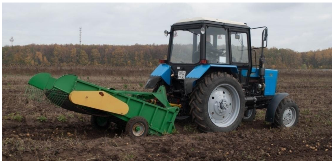
Рисунок 6 – Экспериментальный картофелекопатель КТН-2В, дооборудованный рыхлителем, на учетной делянке
