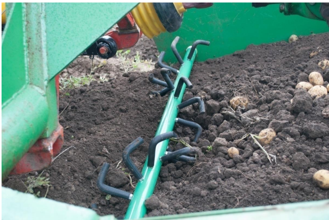
Рисунок 4.3 – Разработанный рыхлитель (патент РФ №213875)
