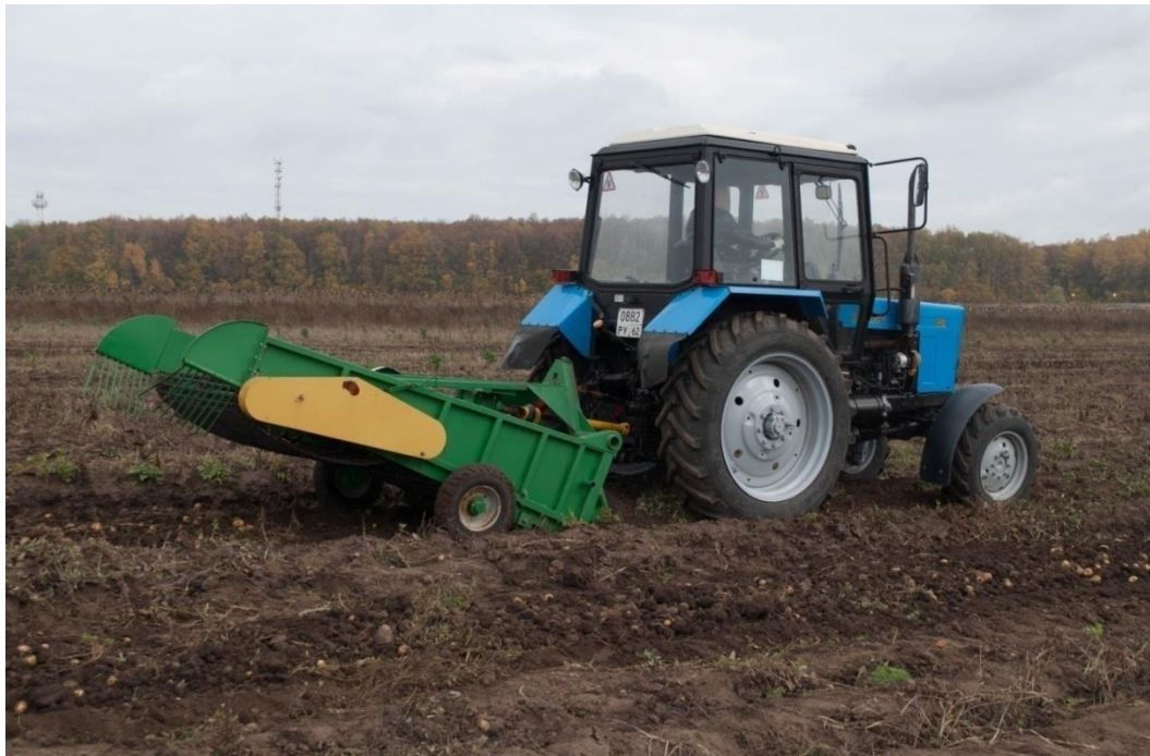
Рисунок 4.2 – Экспериментальный картофелекопатель КТН-2В, дооборудованный рыхлителем, на учетной делянке
