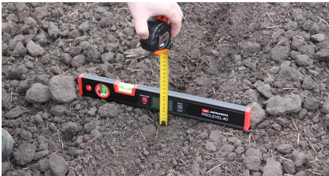
Рисунок 3.10 – Измерение глубины заделки семян сеялки УР 825А
