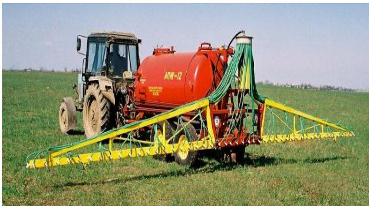
Рисунок 1.2 Машина для внесения жидких минеральных удобрений АПЖ-12 [60]
