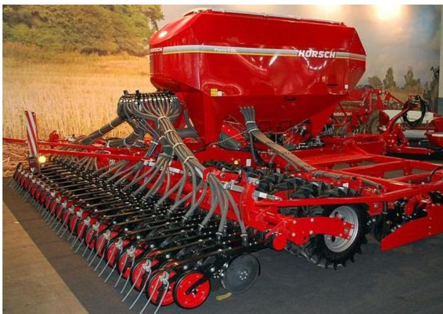
Рисунок 1.5 Сеялка прямого высева ProntoNT
