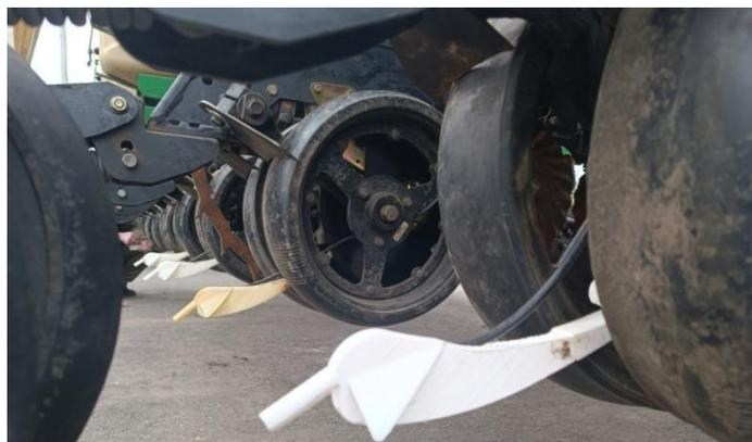
Рисунок 4.3 – Монтаж модернизированных уплотнителей с ФРЭФОСС на сеялку УР 825А
