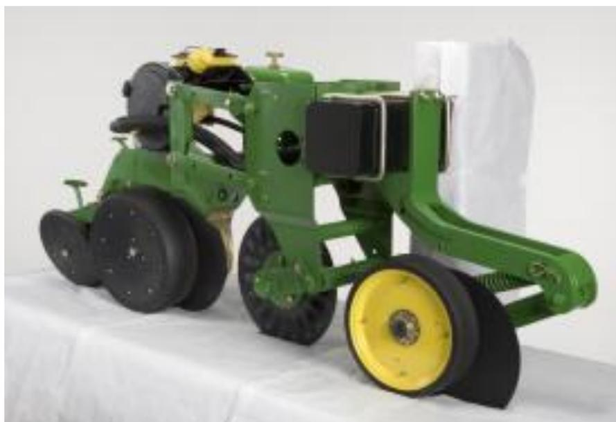
Рисунок 1.15 Сошник для сеялок DohnDeere с двухрядным расположением высевających секций [107]
