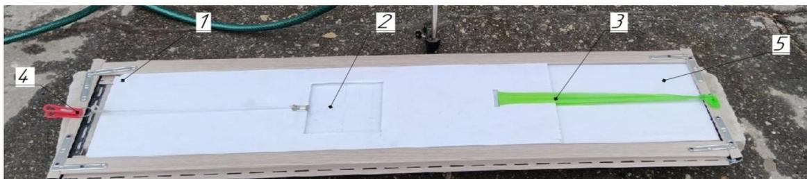
1 – подвижная часть (шторка), 2 – окно прерывателя потока, 3 – резиновый жгут, 4 – прищепка -фиксатор, 5 – неподвижная часть оправки [147]
