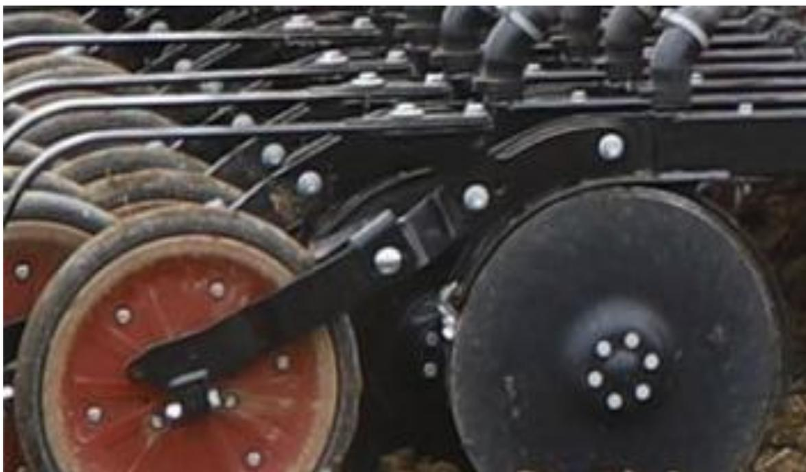
Рисунок 1.16 Двухдисковый сошник Turbodisc сеялки Horsch [106]
