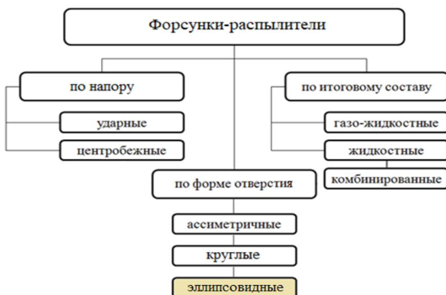
Рисунок 1.8 Классификация форсунок распылителей [145,148]
