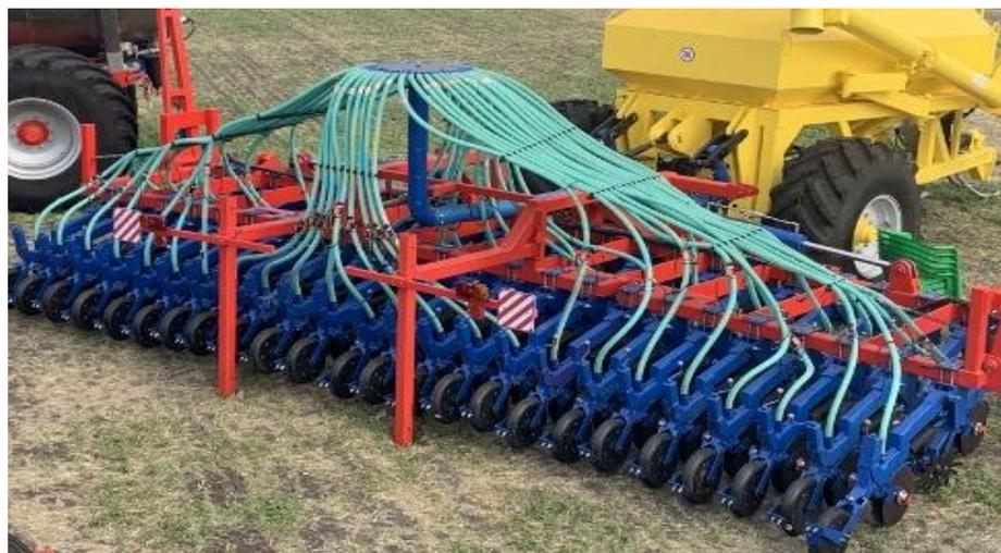
Рисунок 1.4 Зерновая пневматическая сеялка ДОНЭЙР 705 [59]
