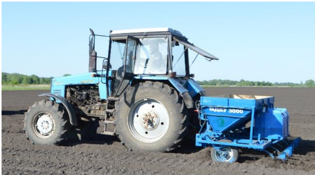
Рисунок 10 – Локальное внесение удобрений с одновременным формированием гребня
