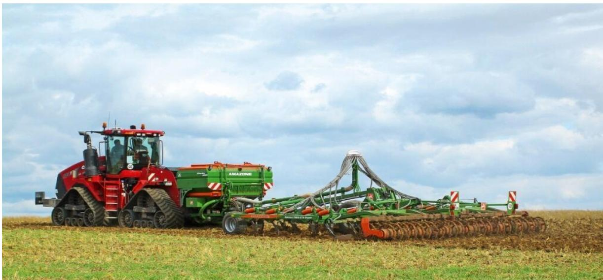
Рисунок 1.2 – Общий вид культиватора-глубококорыхлителя Senius TX с бункером XTender
