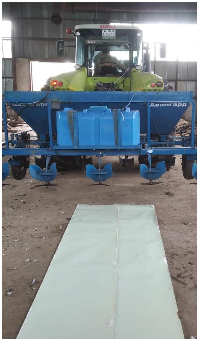
Рисунок 3.3 – Общий вид культиватора-подкормщика при исследовании равномерности распределения удобрений
