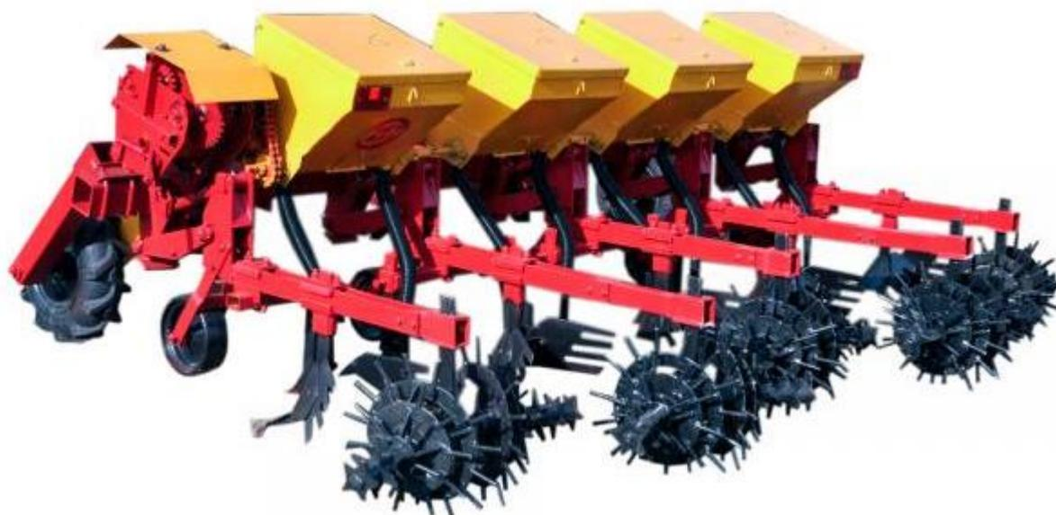
Рисунок 1.1 – Общий вид культиватора окучника навесного КОН-2,8
