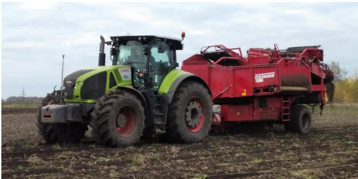
Рисунок 3.10 – Общий вид уборочного агрегата: трактор CLAAS Axion 940 и картофелеуборочный комбайн GRIMME SE 150-60
