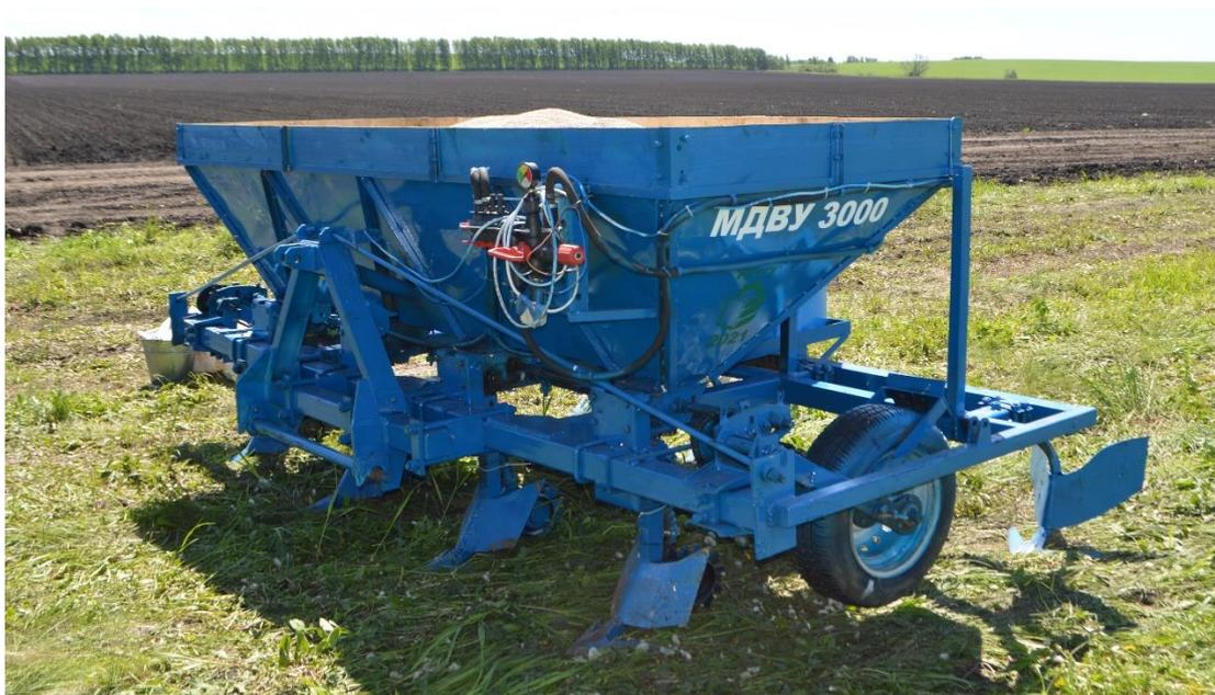
Рисунок 3.1 – Общий вид культиватора-подкормщика
