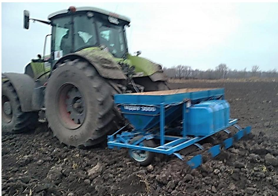
Рисунок 3.7 – локальное внесение твердых минеральных удобрений и гумата калия при помощи культиватора-подкормщика
