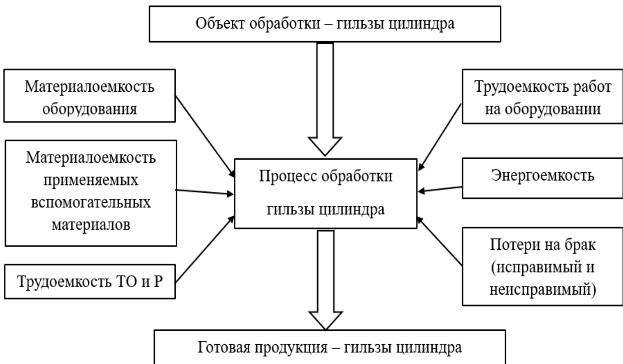
Рисунок 2 – Схема оценки качества технологического процесса обработки с помощью показателей ресурсоемкости
