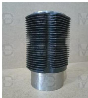
Рисунок 1.16 – Ремонтный комплект Д-144 и гильза цилиндров
