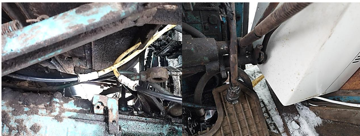
Рисунок 5.15 – Врезка в штатный топливопровод дизеля Д-243 трактора МТЗ-80 и заведение ответвления топливопровода в зону обработки волнами СВЧ диапазона
