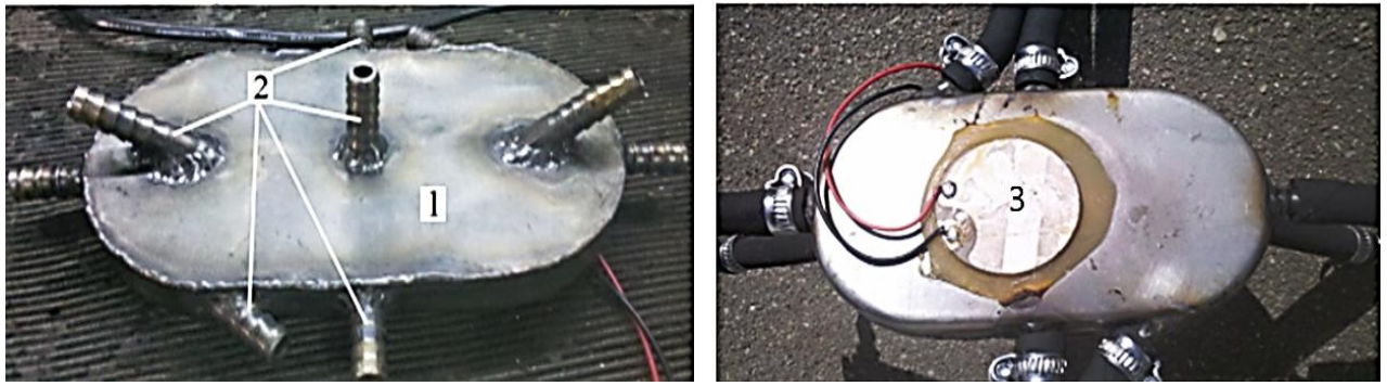
Рисунок 1.14 – Устройство для обработки топлива ультразвуком: 1 – емкость; 2 – штуцеры; 3 – ультразвуковой излучатель
