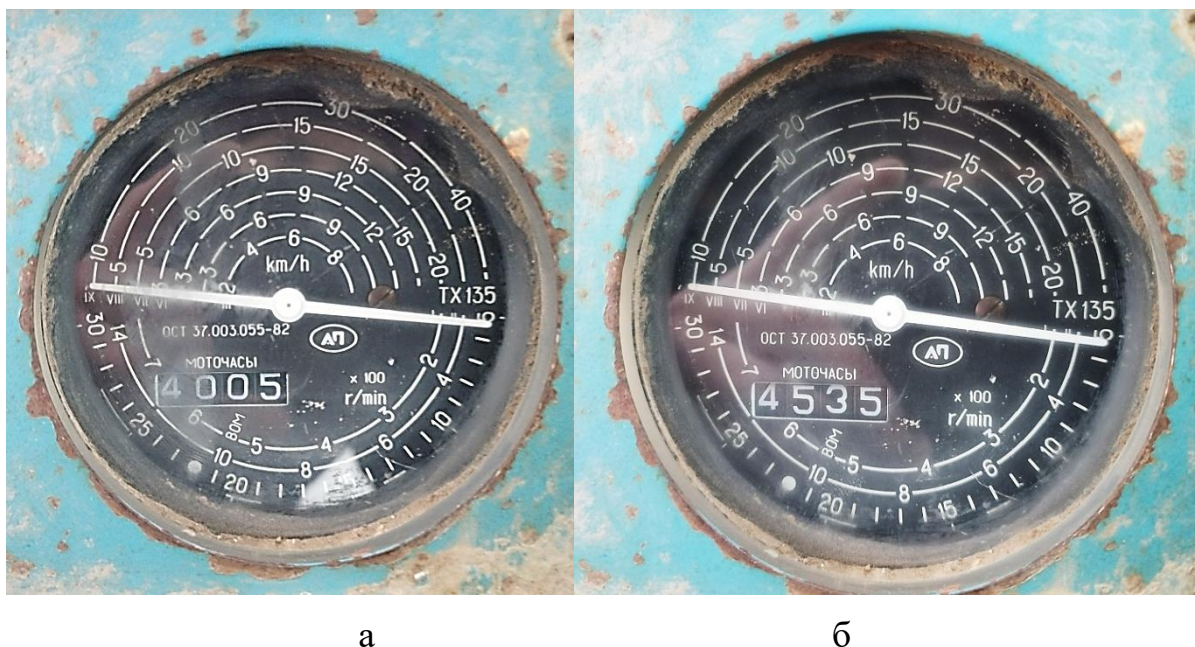
Рисунок 5.17 – Показания контрольных приборов трактора МТЗ-80: а – до начала производственных испытаний; б – после их проведения
