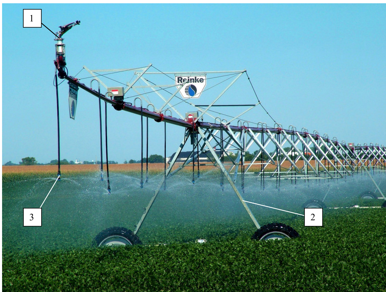
1 – концевой дождевальный аппарат; 2 – самоходная тележка; 3 – дождеобразующие насадки
