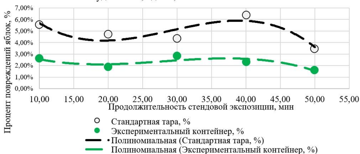
Рисунок 7 – Графическая зависимость повреждения яблок, %, от продолжительности исследования, мин, при частоте 2,8 Гц с амплитудами от 5,0 – 35,0 Гц
