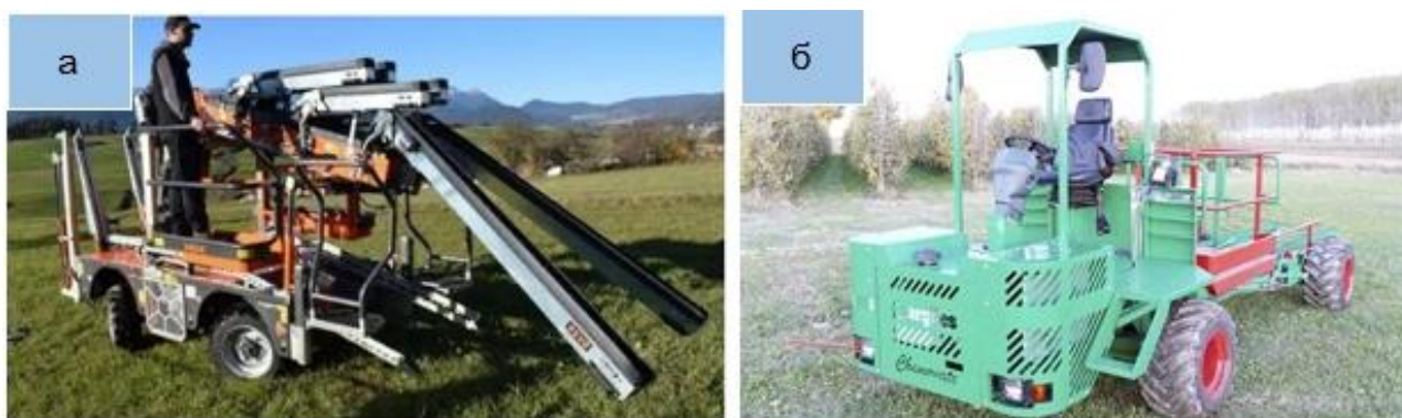
а - общий вид самоходной плодуборочной платформы «Piuma 4WD» (Италия); б - автономный контейнеровоз для сбора урожая "АФ-РР" разработан в Ростове-на-Дону.
