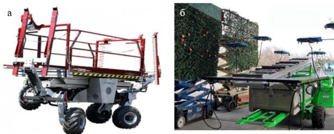
Рисунок 1.18 – Общий вид самоходной платформы для сбора фруктов «Cross Eco Südtirol 135»
