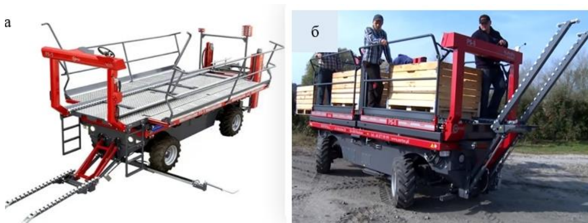
Рисунок 1.17 - Общий вид самоходной плодуборочной платформы «PS-5»
