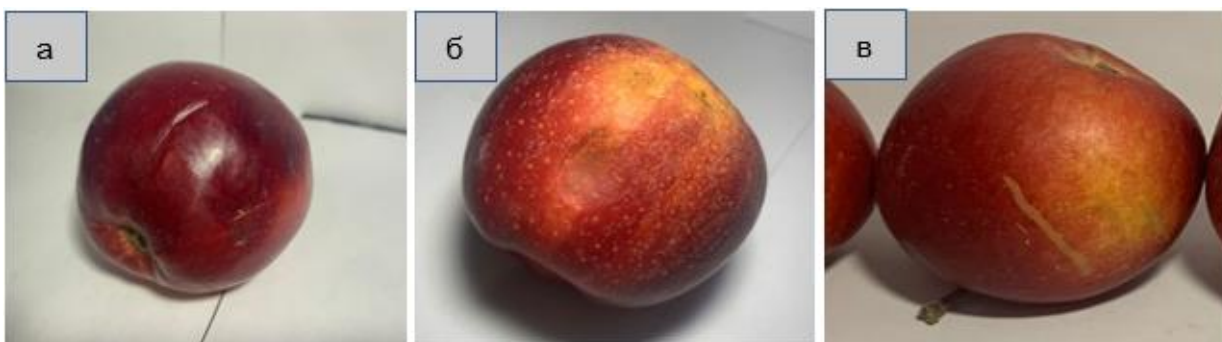
Рисунок 4.1 - Повреждения, полученные плодами во время проведения испытаний
