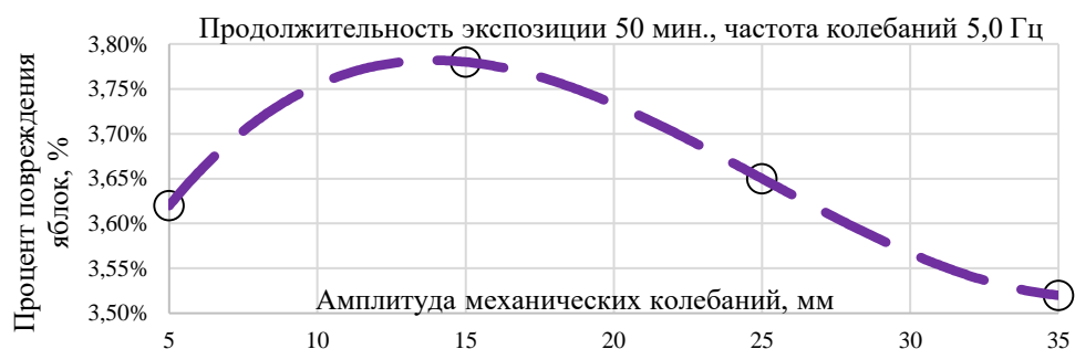
Рисунок Б.3 - Результаты исследований зависимости повреждения яблок, %, транспортируемых в стандартной таре, при частоте колебаний 5,0 Гц
