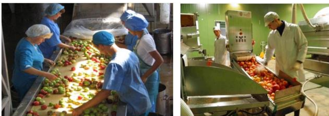
Рисунок 1.23- Сортировка и калибровка яблок ручным и механическим способом
