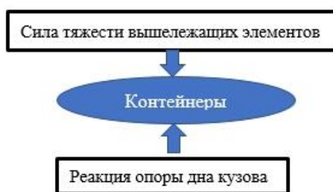
Рисунок 3.8 – Статическая схема механических воздействий на груз при его транспортировке
