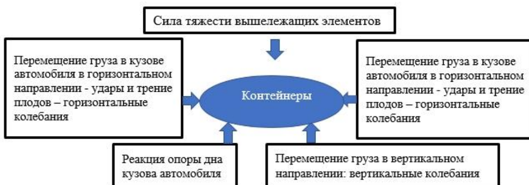
Рисунок 3.9 – Динамическая схема механических воздействий на яблоки при их транспортировке
