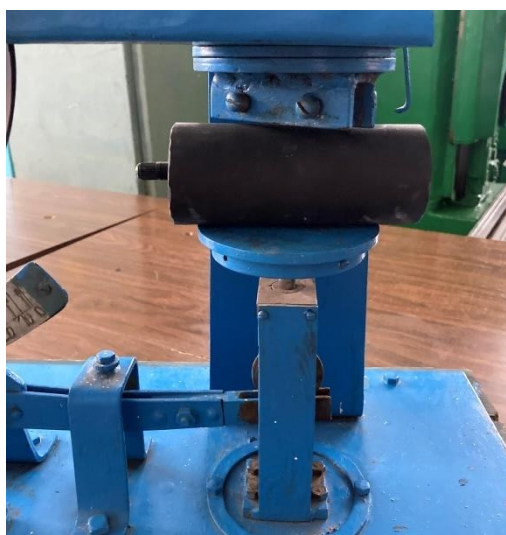
Рисунок 3.1 - Установка для определения характеристик упругих элементов устройства отделения примесей
