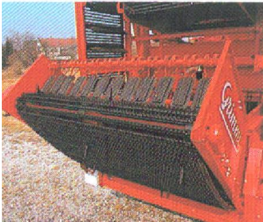
Рисунок 1.20 – Пальчатая горка картофелеуборочной машины Grimme DR1500 и подпружиненные отбойные пластины
