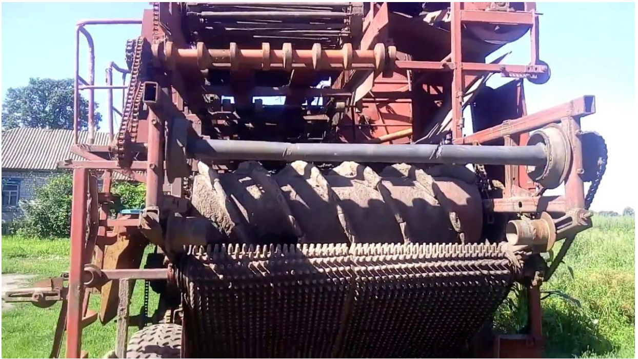
Рисунок 1.19 – Пальчатая горка картофелеуборочной машины КПК-2-01
