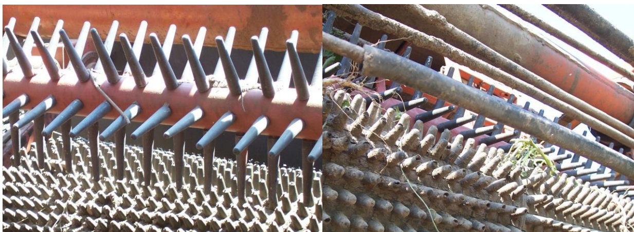
Рисунок 1.24 – Устройство для отделения корнеклубнеплодов от примесей на комбайне КПК-2-01 [78]
