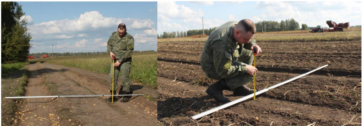
Рисунок 3.14 - Измерение рельефа почвы после проезда сельскохозяйственной техники
