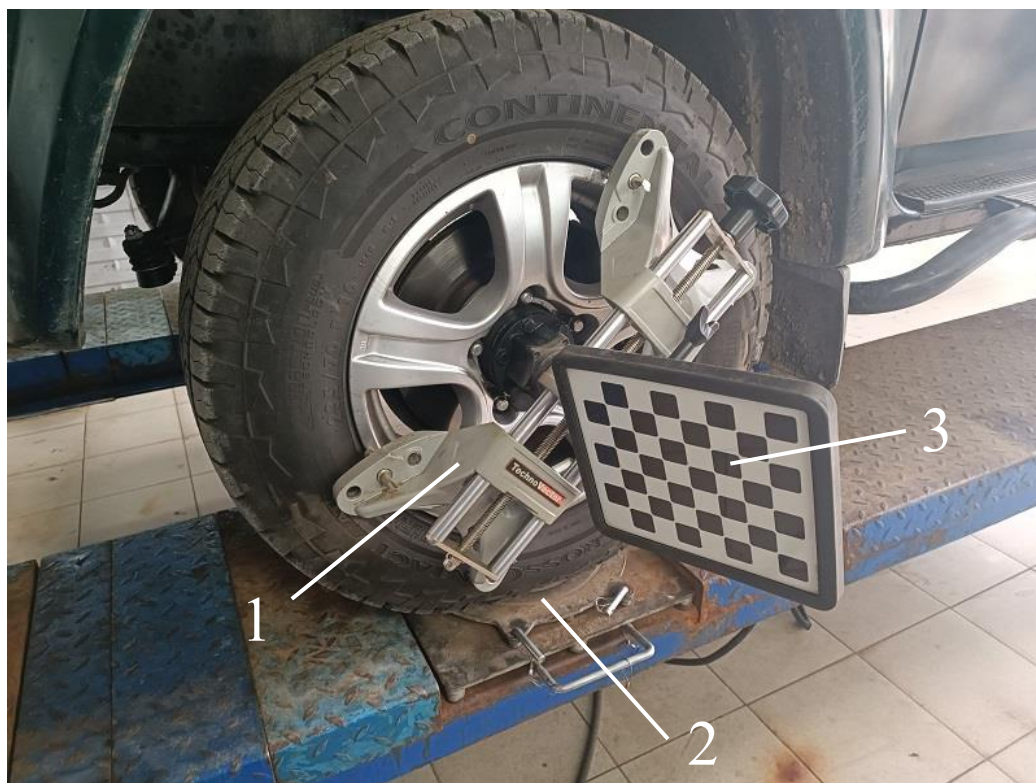
1 – Колёсные адаптеры (захваты); 2 – передние поворотные платформы; 3 – измерительные мишени
