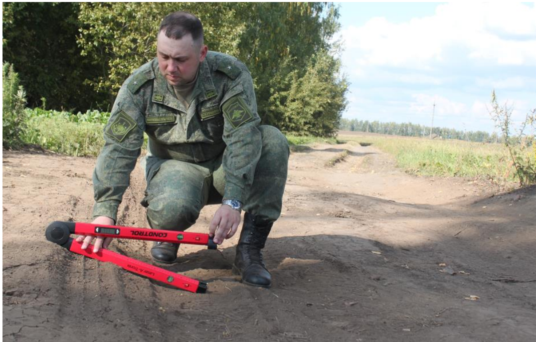
Рисунок 3.17 – Измерение углов поперечных неровностей (колеи)
