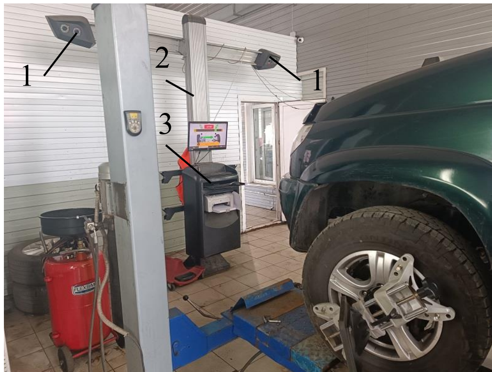
1 – видеокамеры; 2 – Т-образная стойка, закреплённая на компьютерной стойке; 3 – компьютерная стойка
