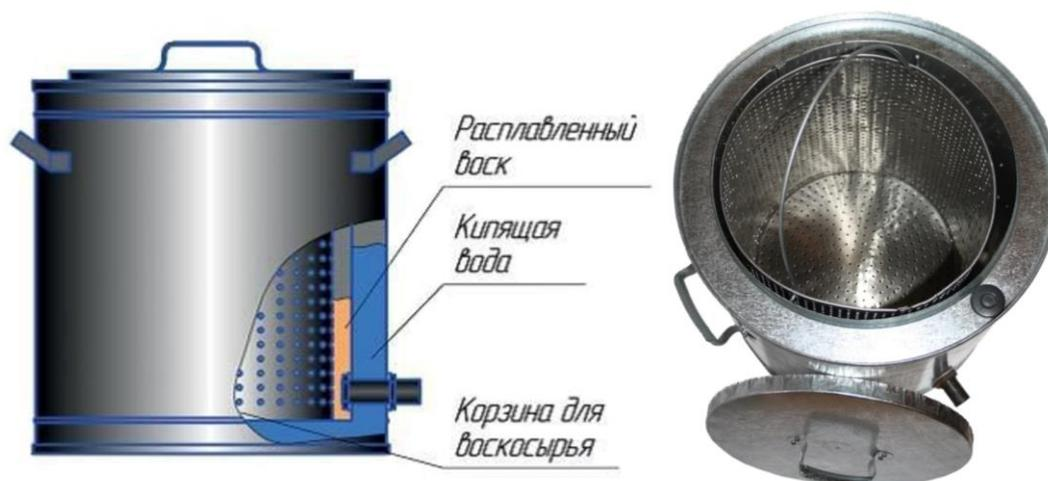
Рисунок 1.8 – Устройство воскотопки парового типа
