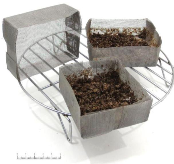
Рисунок 5.15 – Сетчатые бьюксы с промытым и отфильтрованным восковым ворохом
