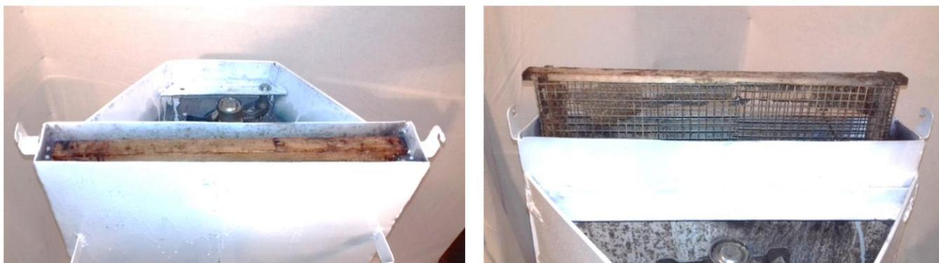
Рисунок 7.6 – Корпус гидровибрационной установки, снабженный сетчатой кассетой
