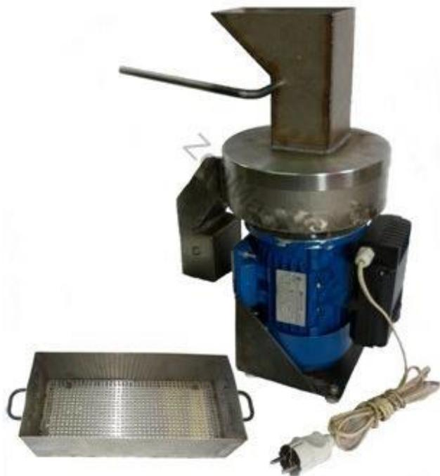
Рисунок 7.7 – Общий вид опытного образца установки для извлечения перги из перговых сотов АИП-10
