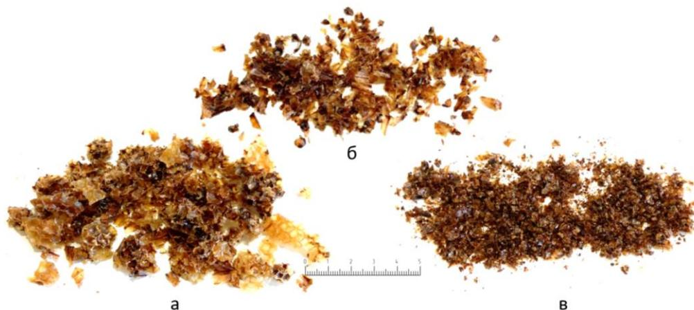
Рисунок 3.2 – Подготовленное для проведения опытов измельченные фракции воскового сырья, лишённые загрязнений: а – усредненный размер частиц > 6 мм; б – усредненный размер частиц 5 мм; в – усредненный размер частиц 3 мм
