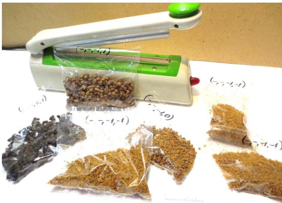
Рисунок 3.5 – Перга, сортированная по влажности и гранулометрическому составу (первый этап, заключающийся в подготовке всех исследуемых навесок и оборудования)
