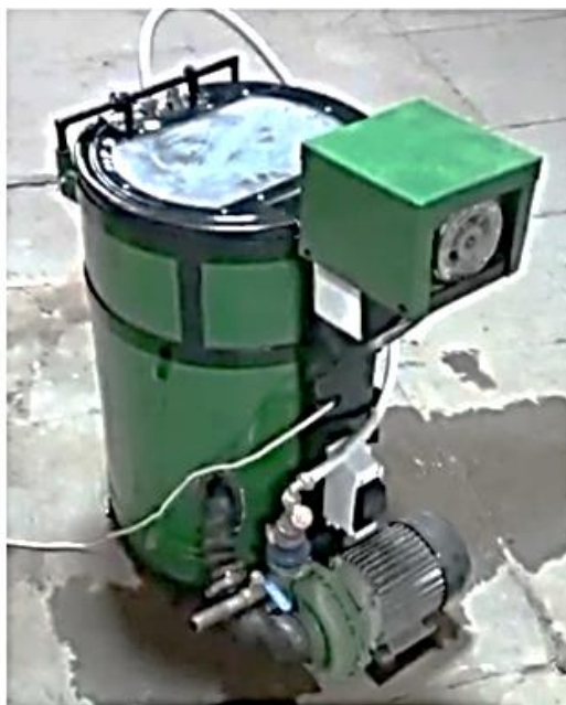
Рисунок 3.1 – Оригинальная моечная установка для мойки деталей погружением в раствор
