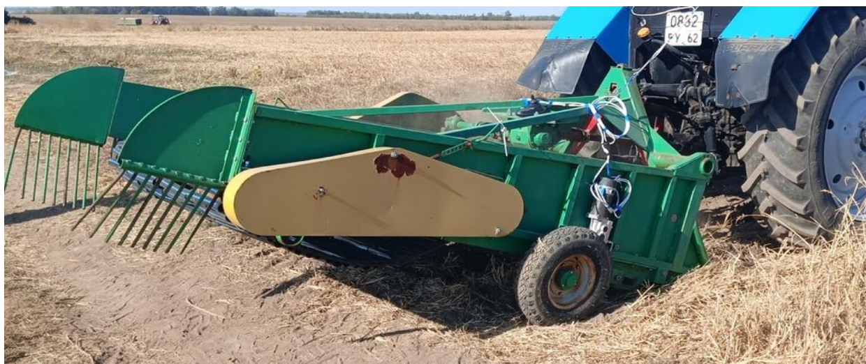
Рисунок 7 - Картофелекопатель, оснащенный встряхивателем сепарирующего органа с приводными эксцентриковыми роликами
