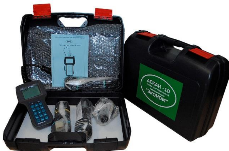
Рисунок 3.10. – Диагностический тестер АСКАН–10 для диагностирования технического состояния трактора «Кировец К – 5»
