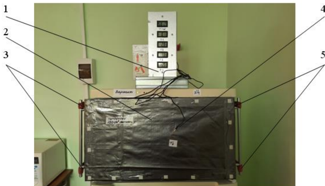
Рисунок 3.10 – Наибольшая грань экспериментальной панели, обтянутая укрывным материалом при втором этапе исследования
