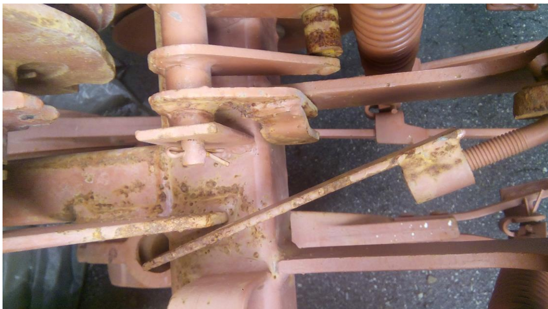
Рисунок 1.3 – Очаги коррозионного разрушения на элементах конструкции сельскохозяйственной техники
