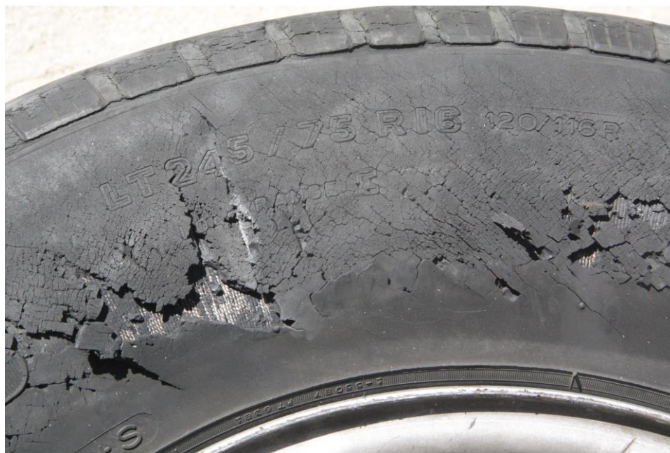
Рисунок 1.6 – Фрагмент автомобильной шины с признаками озонного старения
