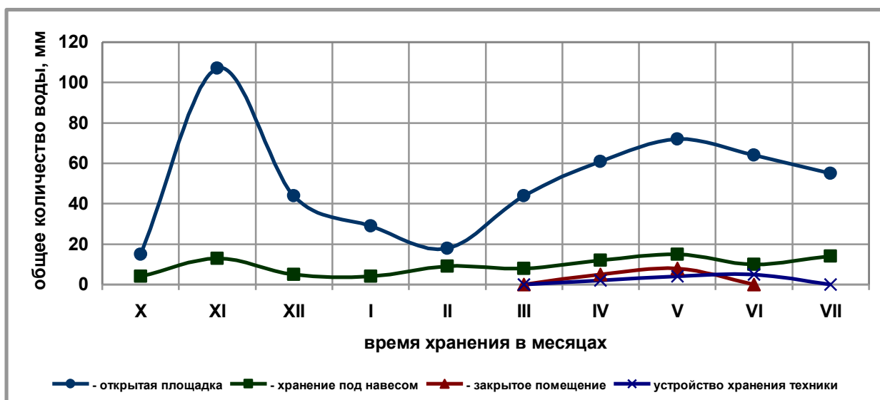
Рисунок 4.8 – Общее количество воды на поверхности СХТ
