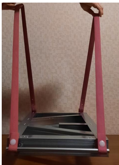
Рисунок 3.2 – Способ фиксации экспериментальной панели на контуре рабочего проема морозильной камеры холодильной установки
