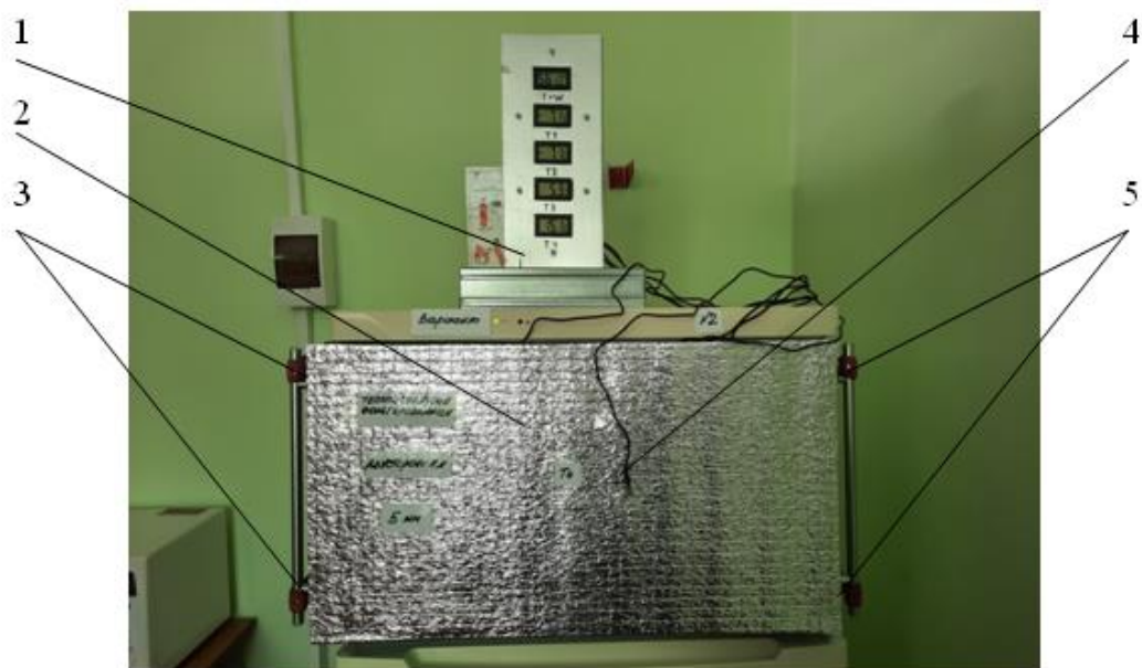
Рисунок 3.6 – Наибольшая грань экспериментальной панели, обтянутая укрывным материалом при первом этапе исследования
