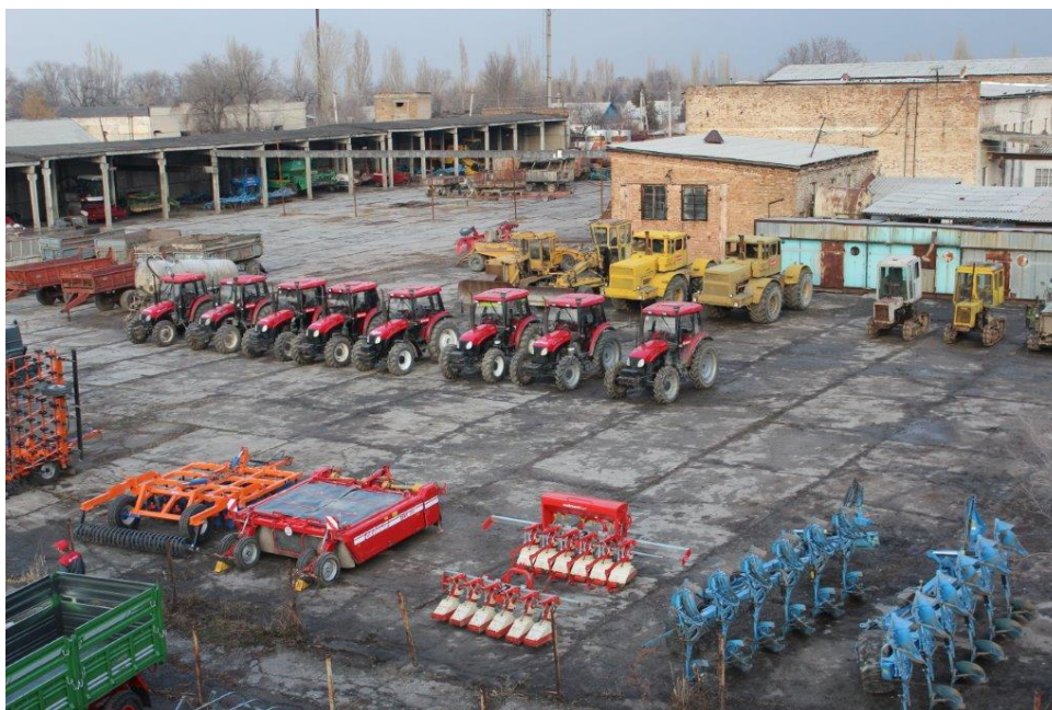
Рисунок 1.9 – Хранение сельскохозяйственной техники на открытой оборудованной площадке
